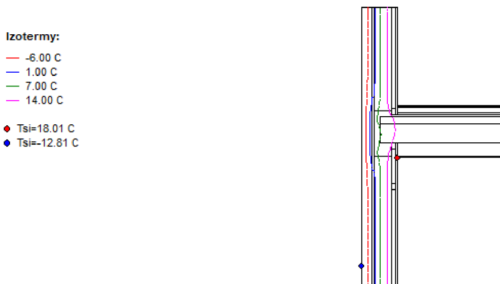
Obrázek 31: Grafický výsledek dvourozměrné simulace – Izotermy
