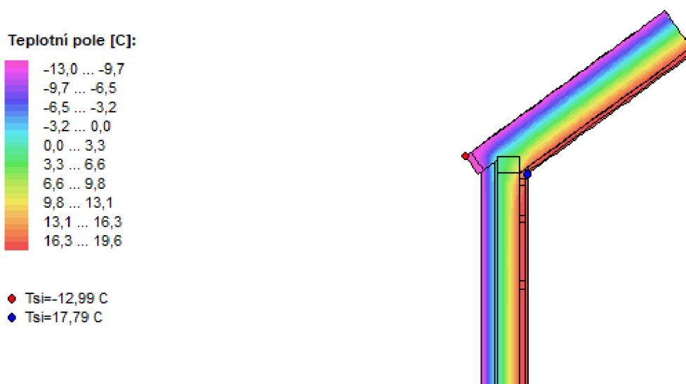
Obrázek 27: Grafický výsledek dvourozměrné simulace – teplotní pole
