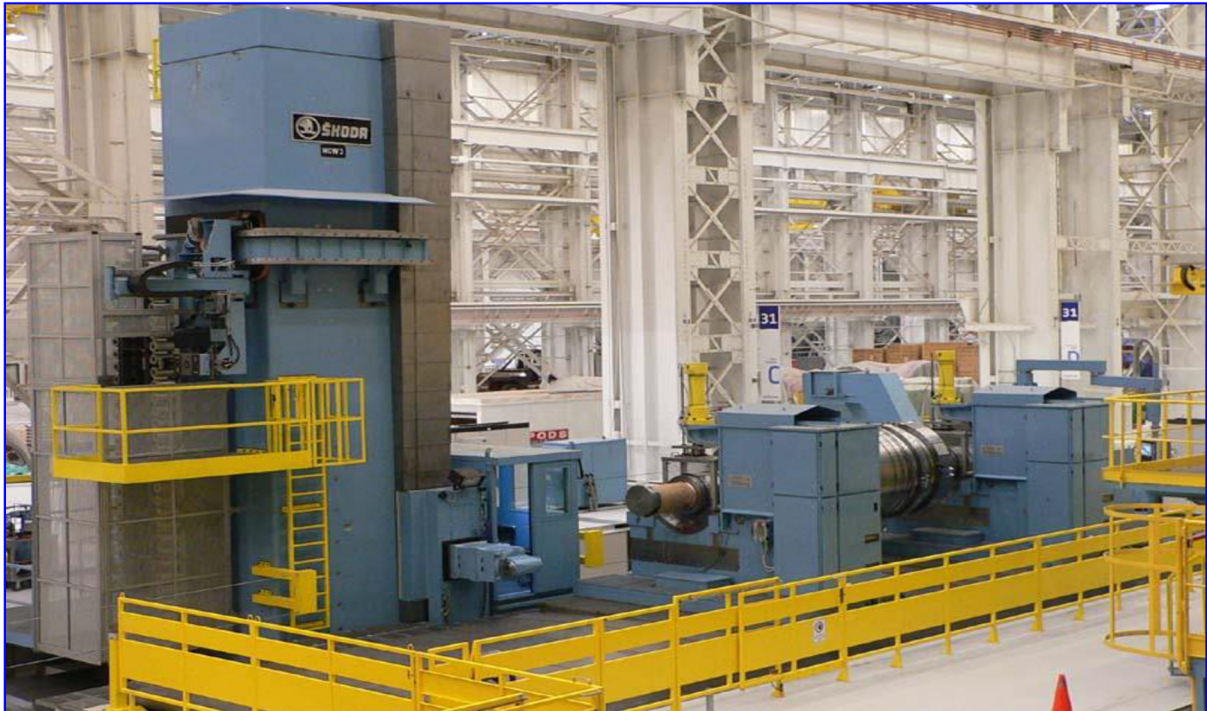
Obr. 28 – Obrábění rotoru plynové turbíny
