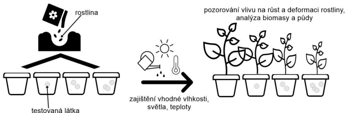
Obrázek 21: Schématické znázornění květináčového experimentu.
