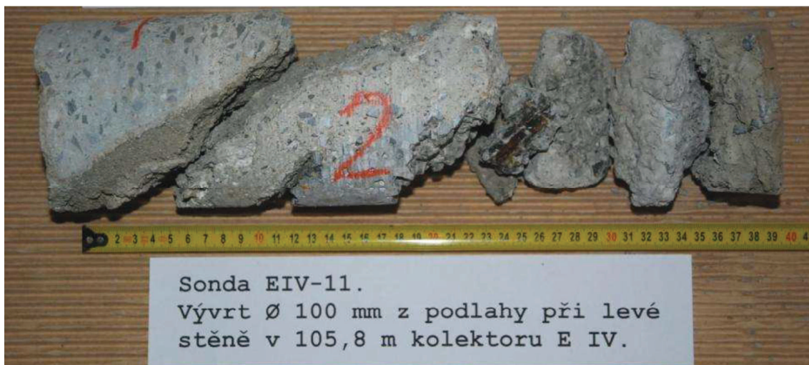
Obr. 4-11. Odebraný jádrový vývrt z podlahy kolektoru v pasu EIV-II. [14]
