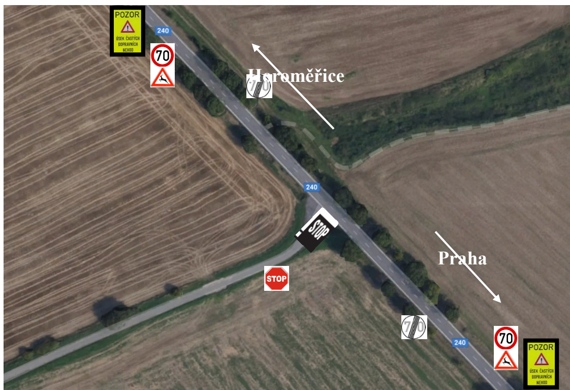
Obr. 4. 9 Navrhovaná úprava úseku
