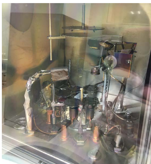
Obr. 28: Napařování hliníkové elektrody
