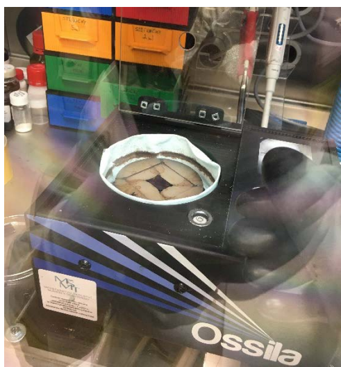
Obr. 27: Nanesení vrstvy fullerenu v inertní atmosféře
