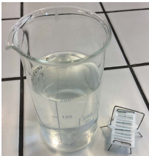
Obr. 20: Čištění substrátu v tenzidu
