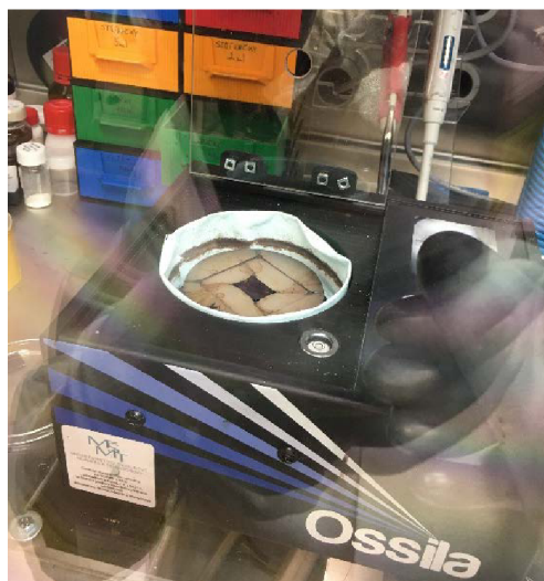
Obr. 27: Nanesení vrstvy fulleremu v inertní atmosféře
