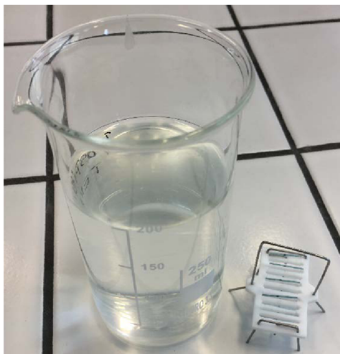
Obr. 20: Čištění substrátu v tenzidu
