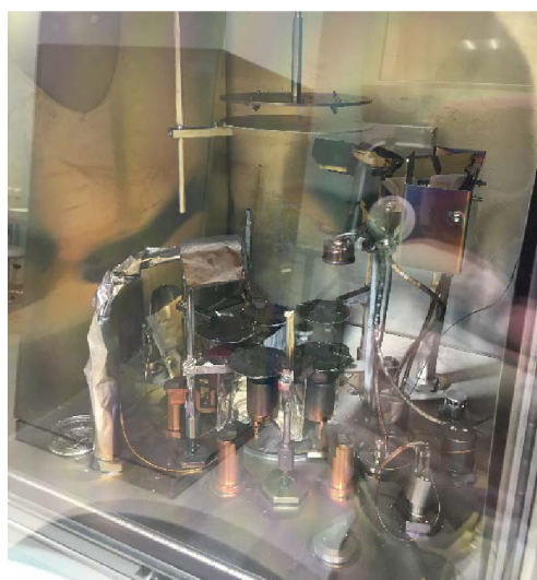
Obr. 28: Napařování hliníkové elektrody
