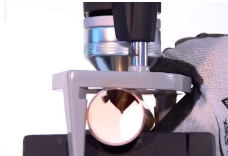
Obr. 10 Tvarování límce zpětným chodem stroje [19]
