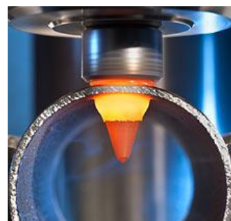
Obr. 37 Vrtání trubky metodou FlowDrill [40]
