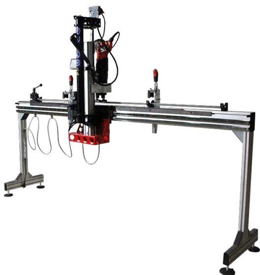
Obr. 61 T-drill HFT-2000 pro ocelové trubky [44]
