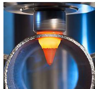
Obr. 37 Vrtání trubky metodou FlowDrill [40]
