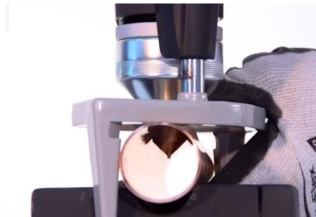
Obr. 10 Tvarování límce zpětným chodem stroje [19]
