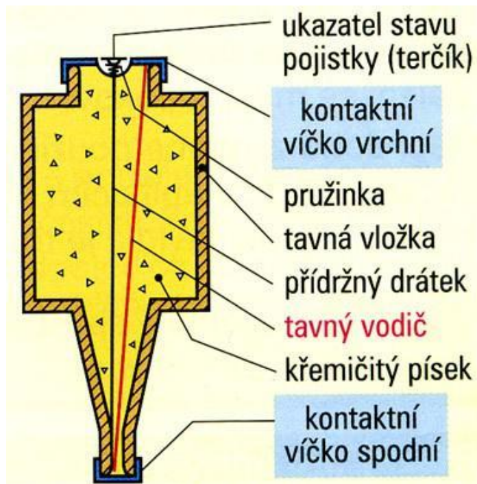
Obrázek 9: Popisu částí a konstrukce tavné pojistky
