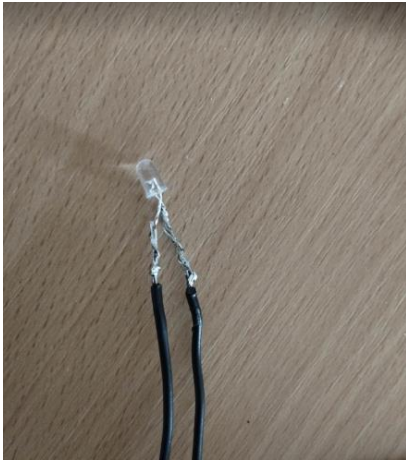
Obrázek 12: Pájený spoj LED diody Zdroj: Vlastní fotografie
