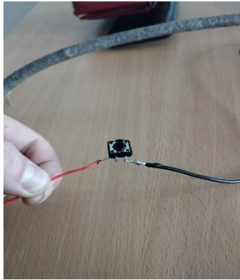
Obrázek 11: Kontrola spojů mikropínače Zdroj: Vlastní fotografie
