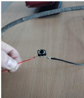
Obrázek 11: Kontrola spojů mikropínače Zdroj: Vlastní fotografie
