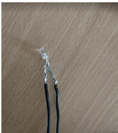
Obrázek 12: Pájený spoj LED diody Zdroj: Vlastní fotografie
