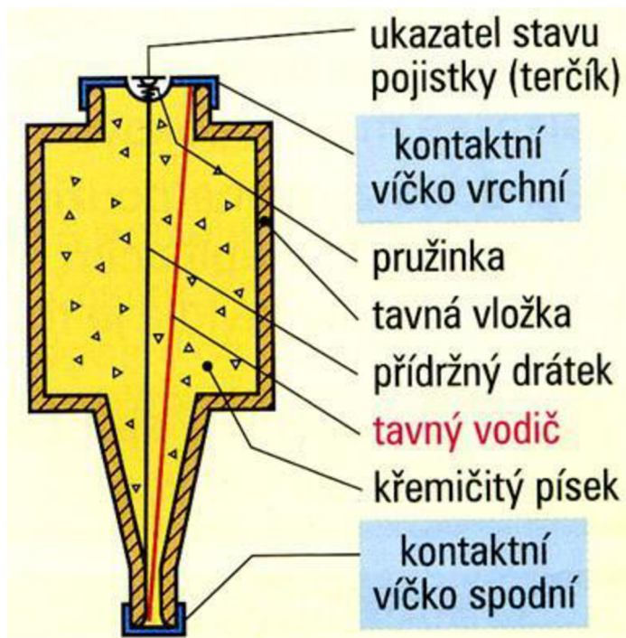
Obrázek 9: Popisu částí a konstrukce tavné pojistky
