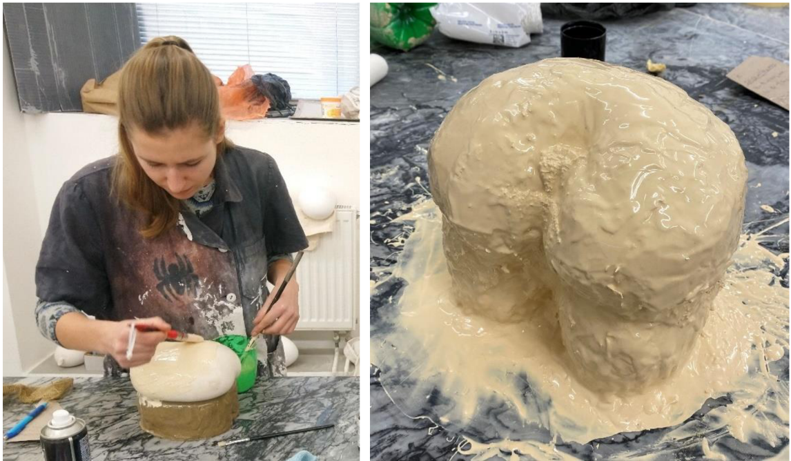
Obrázek 25-26- Natírání modelu kondenzačním silikonem
