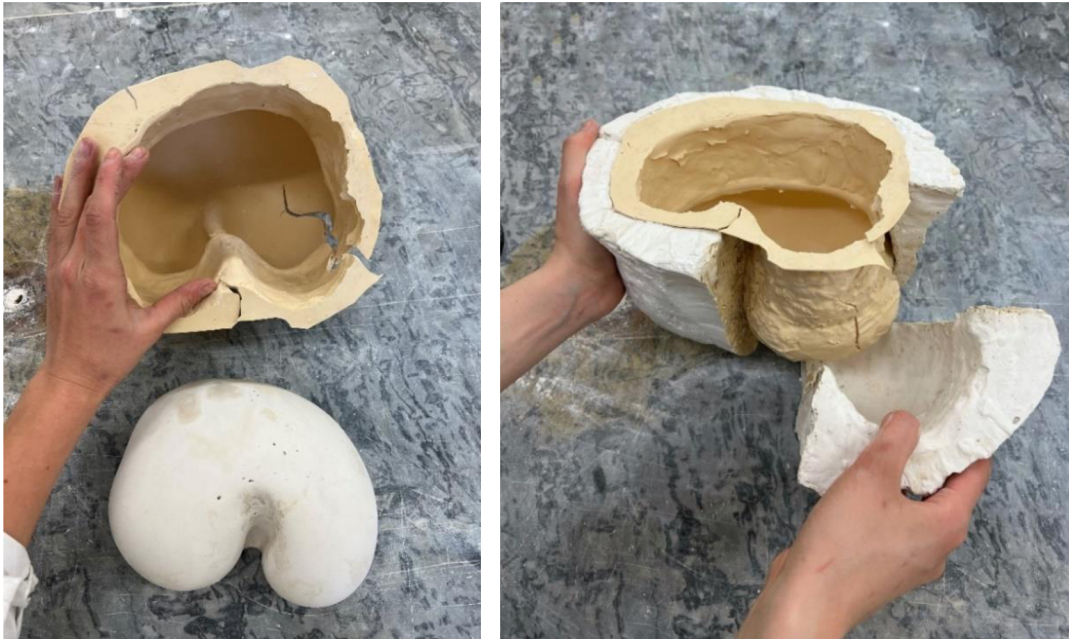
Obrázek 27-28- Silikonová a opěrná sádrová forma
