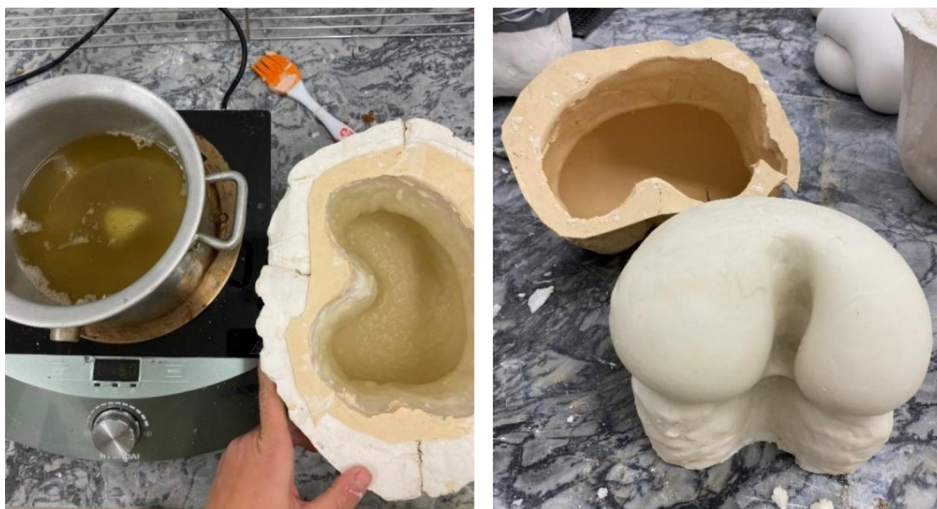
Obrázek 29-30- Vylévání voskem a voskový odlitek
