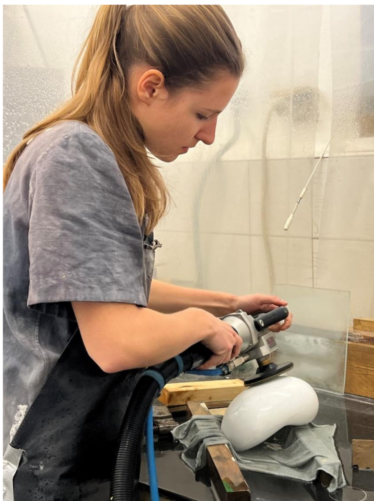
Obrázek 36- Broušení s pneumatickou ruční bruskou (flexou)
