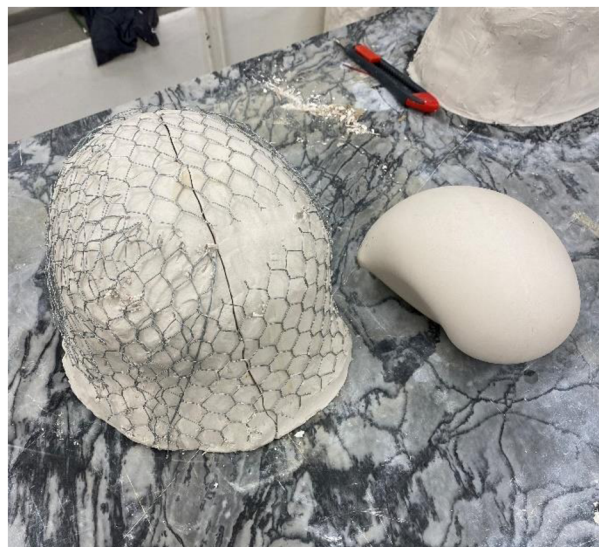
Obrázek 24- Forma po vyndání modelu, obmotaná pletivem, připravená na zalití sádrou
