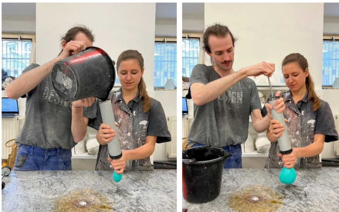
Obrázek 17-18- Postup naplňování balónku sádrou
