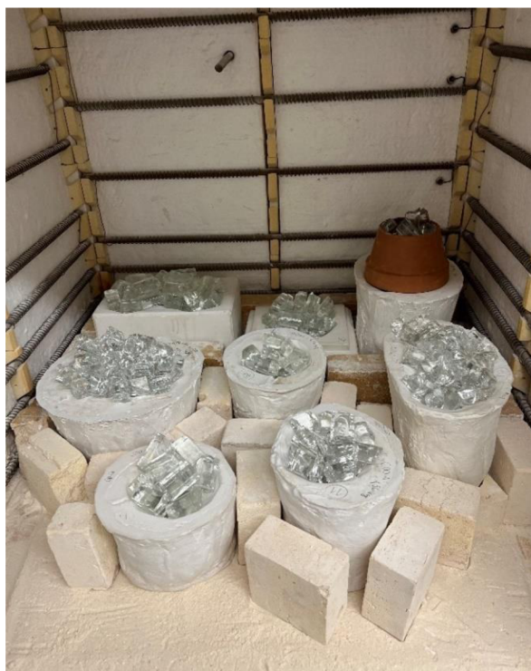
Obrázek 32- Formy se sklem připravené k tavbě
