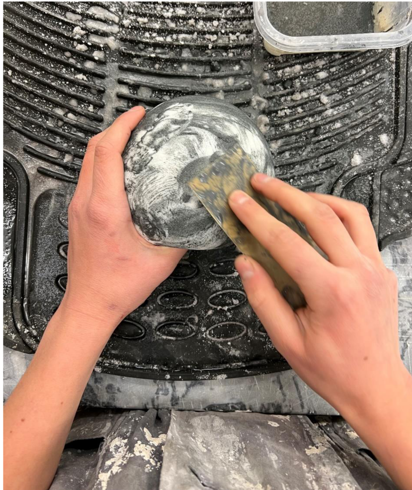
Obrázek 37- Jemnění pomocí plíšku a smirku
