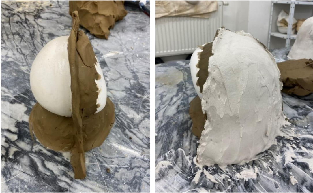
Obrázek 21-22- Formování vícedílné formy
