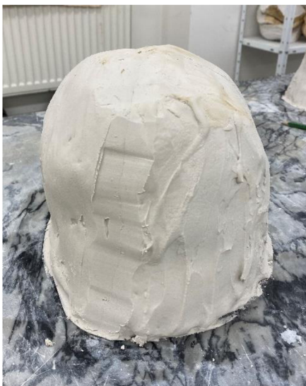
Obrázek 23- Dvoudílná forma těsně po zaformování
