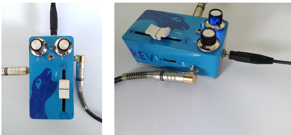
Obr. 4.2: Fotografie vizuální podoby finální verze realizovaného tremola z přední a boční strany.
