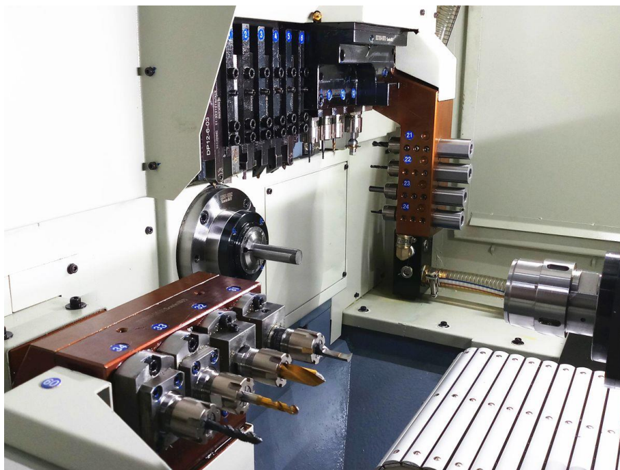
Obr. 7) Pracoviště CNC soustruhu – tzv. dlouhotočného automatu [10]
