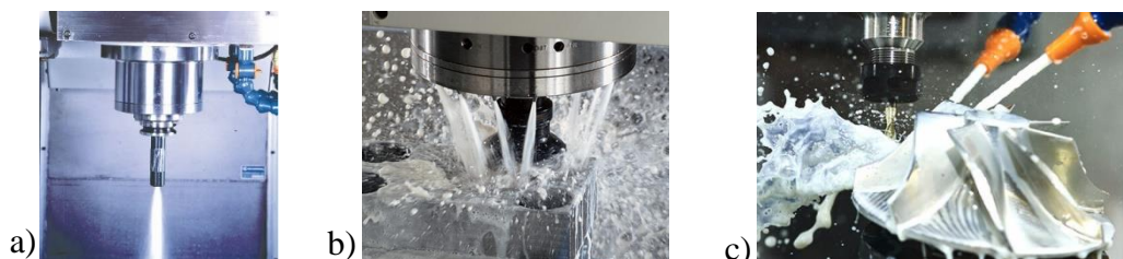
Obr. 64) a) Stopková fréza s vnitřním chlazením [61] b) Chlazení pomocí kroužku s tryskami okolo vřetene [62] c) Chlazení pomocí flexibilní hadice [63]
