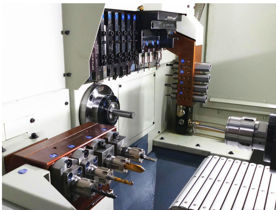
Obr. 7) Pracoviště CNC soustruhu – tzv. dlouhotočného automatu [10]
