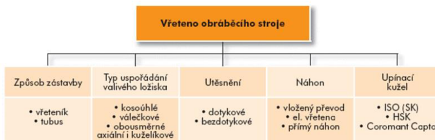
Obr. 30) Morfologie vřeteníku obráběcího stroje [3]
