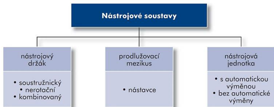
Obr. 3) Morfologie nástrojových soustav obráběcích center [6]
