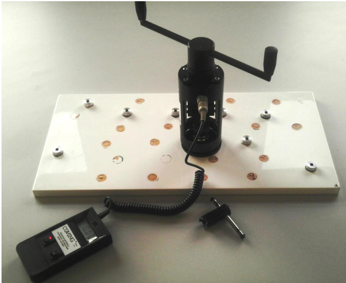
Obr. 19 Provádění odtrhové zkoušky přilnavosti pomocí odtrhoměru
