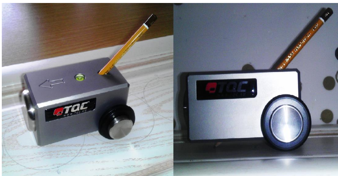
Obr. 16 Pojízdný kvádr TQC VF2378-322 (750g) s vodováhou a vloženou tužkou
