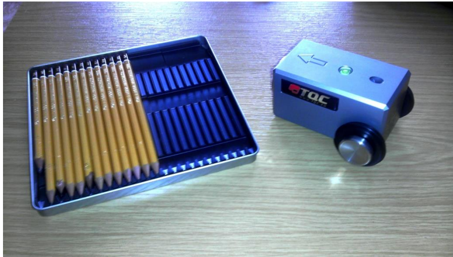
Obr. 11 Sada tužek KOOH-I-NOOR HARDTMUTH s pojízdňm kvádrem TQC
