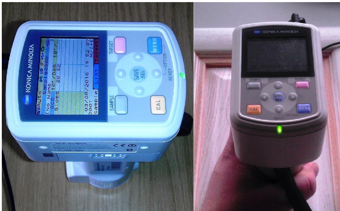
Obr. 15 Měření lesku a barvy spektrofotometrem KONICA MINOLTA CM-600D
