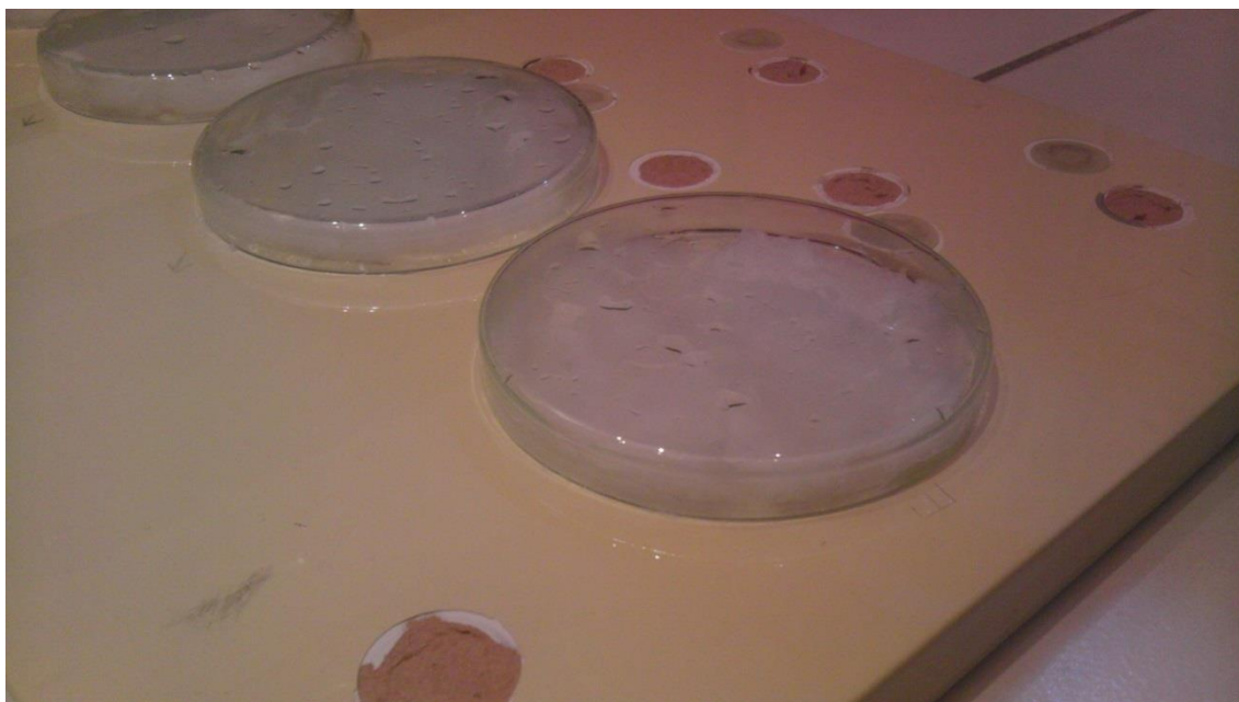
Obr. 20 Působení studených kapalin na povrch dílce ošetřeného nátěrovou hmotou
