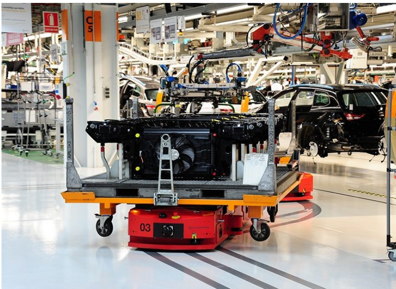
Obr. 4.3 Podbíhací typ AGV jedoucí po magnetické pásce
