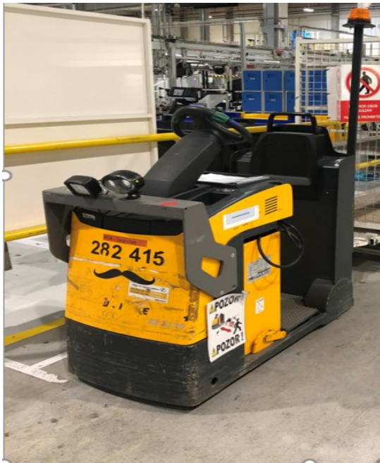
Obr. 4.7 Tahač s plošinou řidiče model EZS 130
