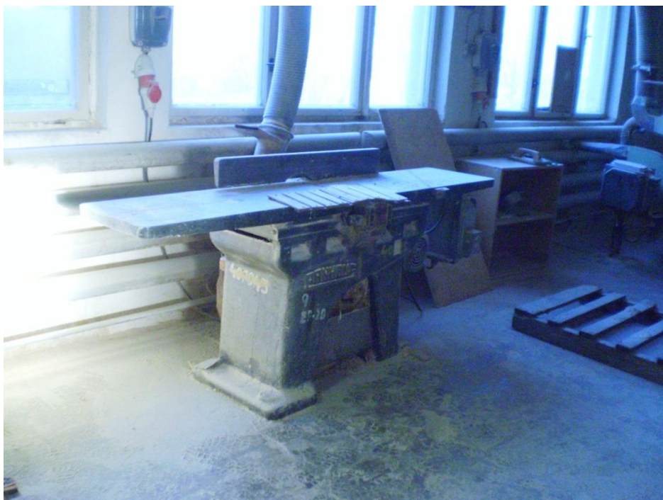
Komentář: Srovnávací hoblovací stroj pro základní úpravu klíčových dílů finalizační produkce
