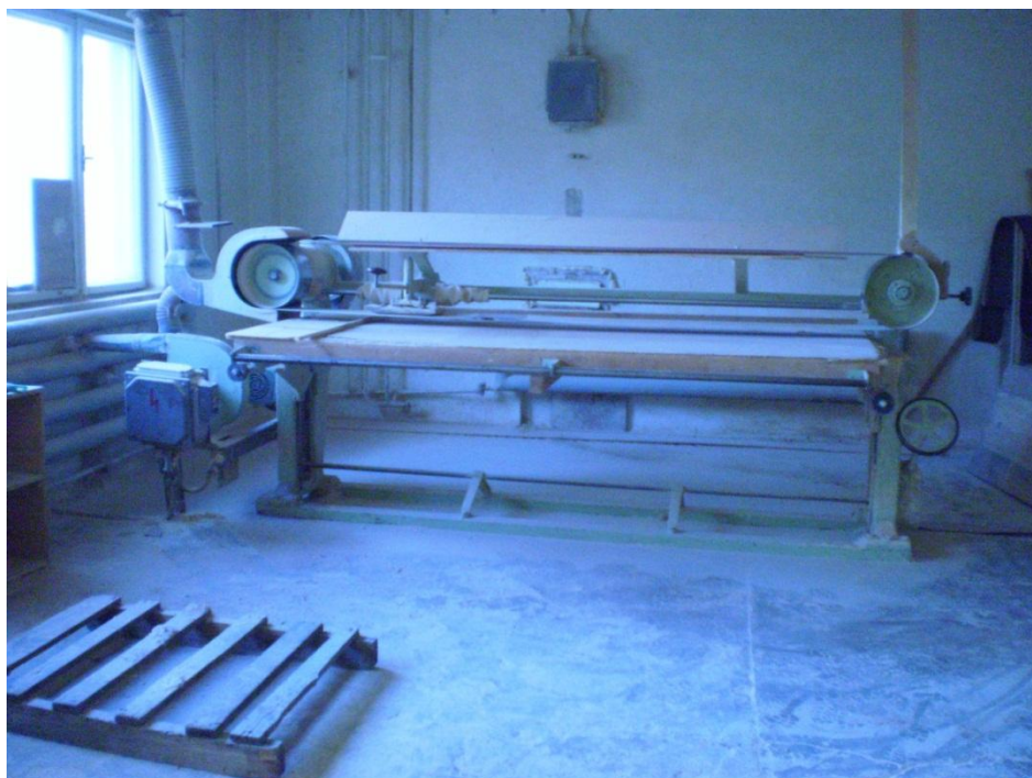
Komentář: Jemná pásová bruska na finalizační úpravu výrobních polotovarů
