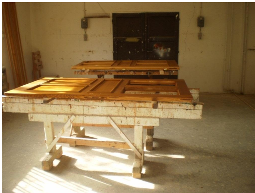
Komentář: Základní lakovací stůl pro výrobu polotovarů
