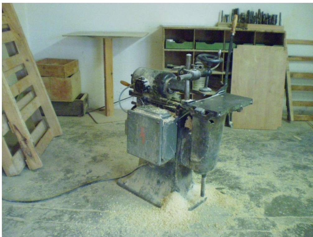
Komentář: Základní horizontální dlabací vrtačka pro segmentaci spojovacích materiálů
