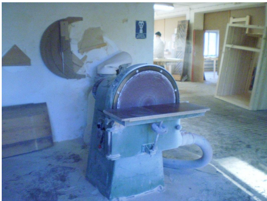
Komentář: Kombinovaná kotoučová bruska pro dokončovací práce
