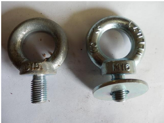
Obr. č. 14: Očnice s podložkou (foto autora, 2017)
