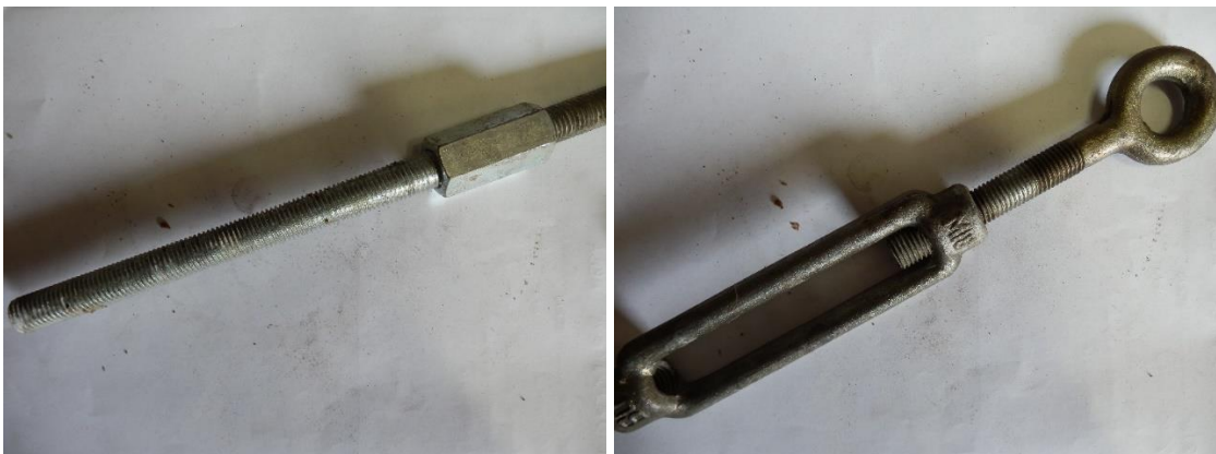
Obr. č. 17: Příklad ocelové závitové tyče Obr. č. 18: Příklad spojení ocelové závitové tyče (foto autora, 2017)
