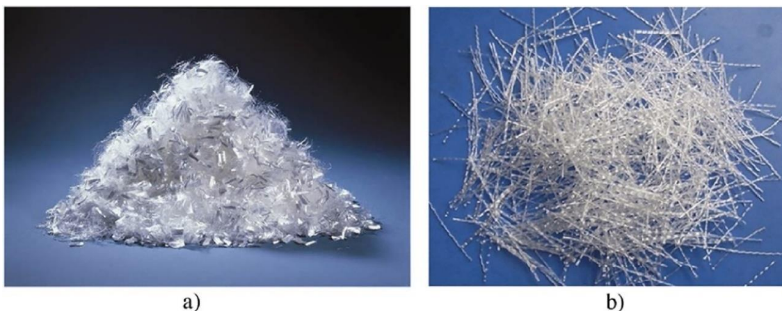
Obrázek 23: Polypropylenová vlákna a) mikrovlákna, b) makrovlákna [70]
