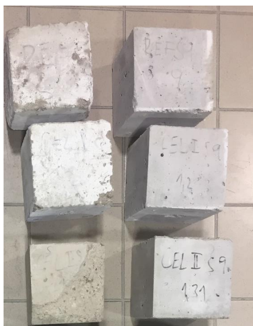
Obrázek 46: Část betonů (CEM II) s přídatkem vláken před a po vysokoteplotním zatěžování
