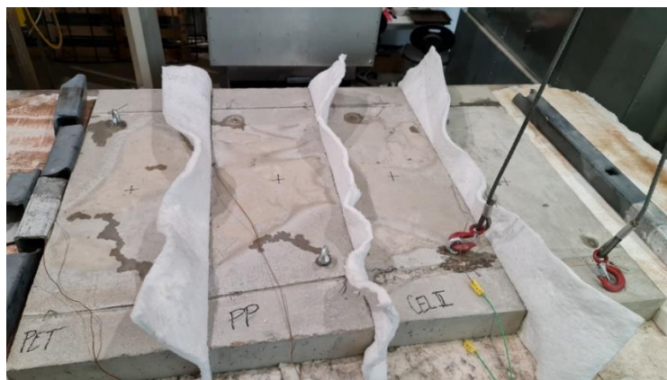
Obrázek 53: Zkušební panely během teplotního zatěžování – pocení
