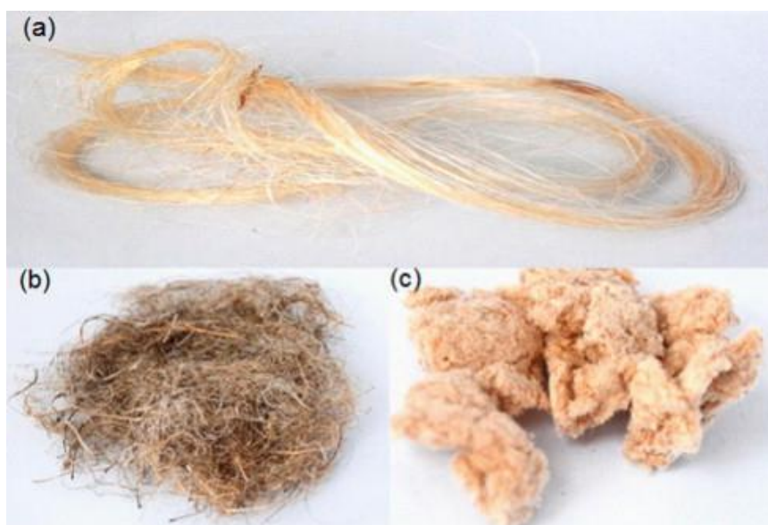
Obrázek 30: Celulósová vlákna v různých formách: a) prameny, b) stříž, c) buničina [90]
