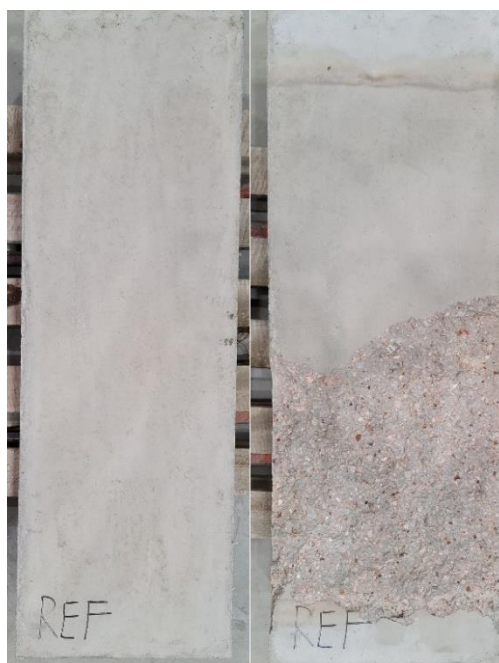
Obrázek 54: Zkušební panel REF před a po vysokoteplotním zatížení
