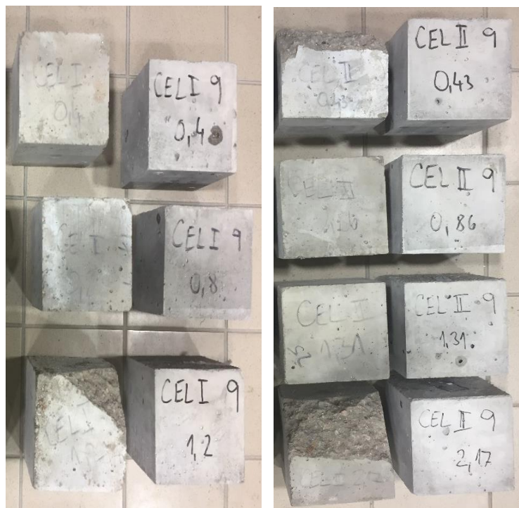
Obrázek 45: Betony s CEM I s přídatkem CEL I (nalevo) a CEL II (napravo) vláken s rostoucí dávkou před a po vysokoteplotním zatěžování
