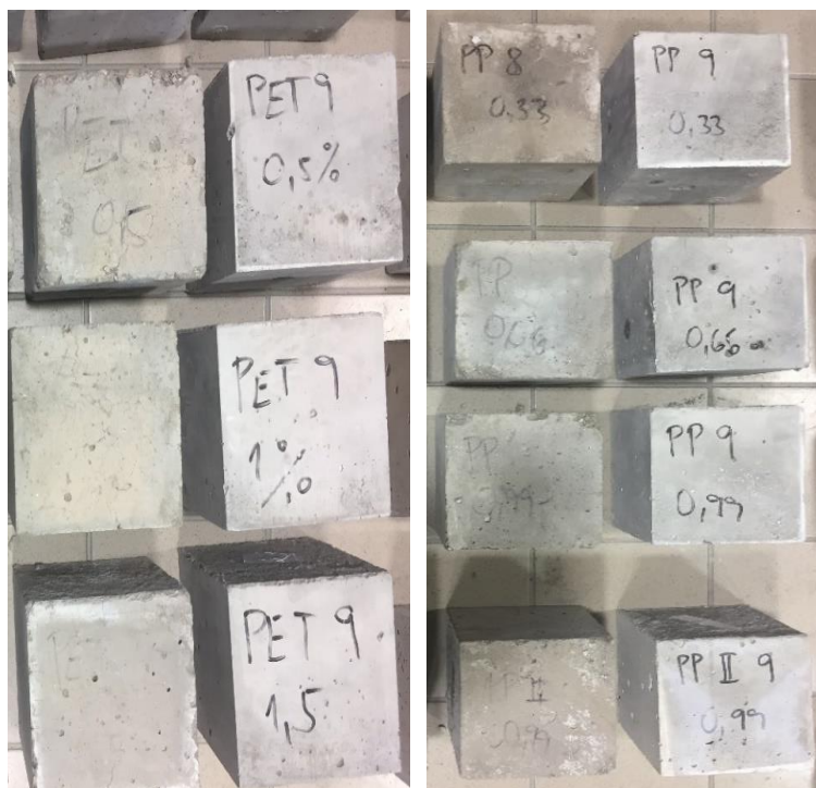
Obrázek 44: Betony s CEM I s přídavkem PET (nalevo) a PP (napravo) vláken s rostoucí dávkou před a po vysokoteplotním zatěžování
