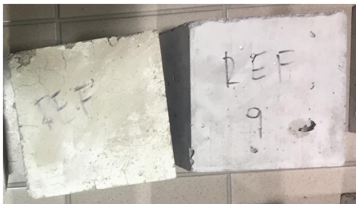
Obrázek 43: Referenční betony s CEM I před a po vysokoteplotním zatížení
