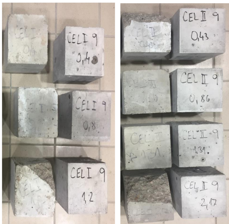
Obrázek 45: Betony s CEM I s přidavkem CEL I (nalevo) a CEL II (napravo) vláken s rostoucí dávkou před a po vysokoteplotním zatěžování
