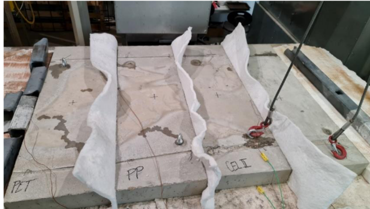
Obrázek 53: Zkušební panely během teplotního zatěžování – pocení
