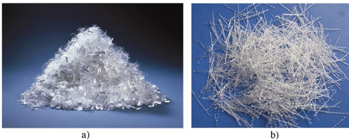
Obrázek 23: Polypropylenová vlákna a) mikrovlákna, b) makrovlákna [70]
