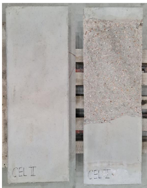
Obrázek 57: Zkušební panel CEL II před a po vysokoteplotní zatížení
