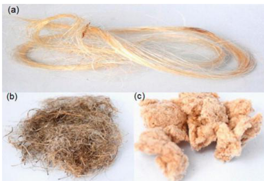
Obrázek 30: Celulózová vlákna v různých formách: a) prameny, b) stříž, c) buničina [90]
