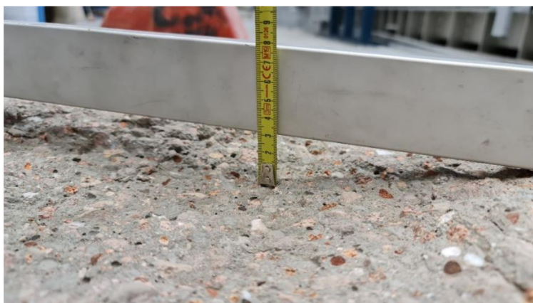
Obrázek 55: Měření hloubky odprýsknutí na panelu REF
