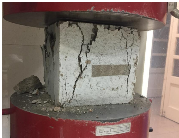
Obrázek 42: Pohled na zkoušení zbytkové pevnosti v tlaku
