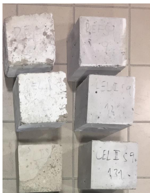
Obrázek 46: Část betonů (CEM II) s přidavkem vláken před a po vysokoteplotním zatěžování
