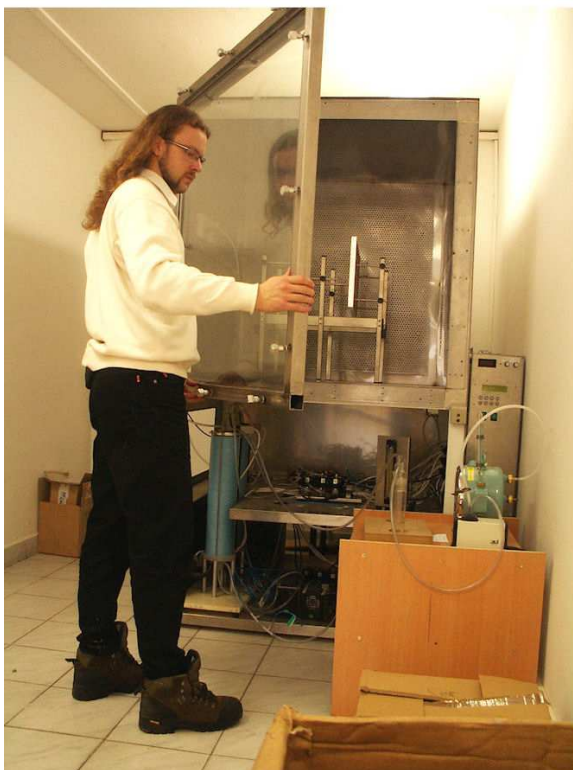
Vkládání zkušebních vzorků do komory.
