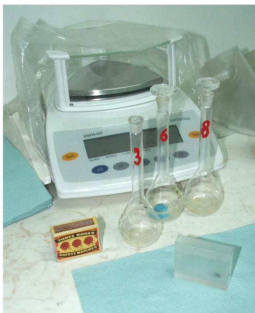
Kyveta 50 mm., baňky objemu 50 ml, laboratorní váha s přesností na 0,001g.
