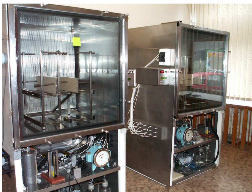
Dvě malé komory o objemu 1 m 3 v provozu. Pod vlastní zkušební komorou je zařízení pro úpravu vstupujícího vzduchu do komory.
