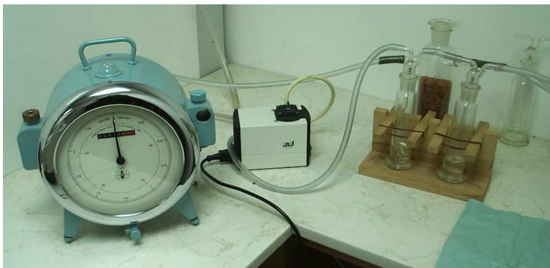
Odběrové zařízení pro velkou komoru. Z levé strany vidíme bubnový laboratorní plynoměr, elektrická membránová vývěva, dvě promývací lahve.
