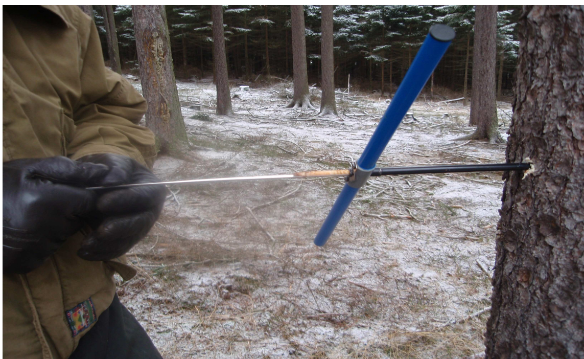
Obr. č.7 - Odběr vzorků pomocí přírůstkového vrtáku
