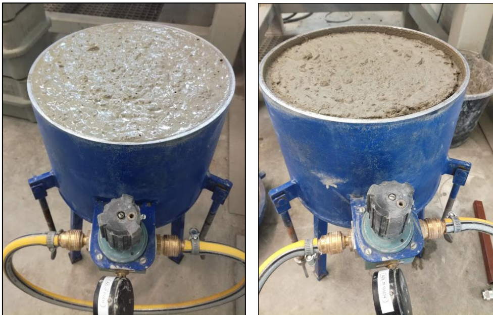
Obr. 57, 58: Betonová směs v tlakové nádobě před zkouškou (vlevo) a po 60 minutách působení tlaku 300 kPa (vpravo)
