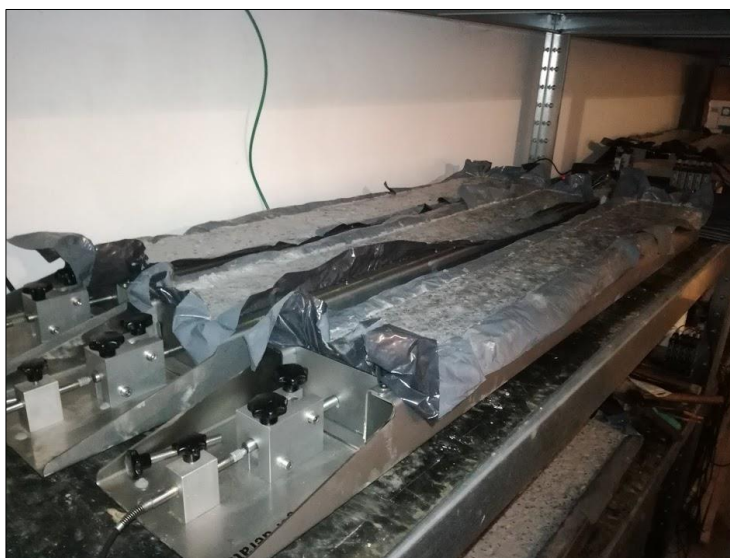
Obr. 60: Zkušební formy z nerezové oceli pro stanovení objemových změn betonu
