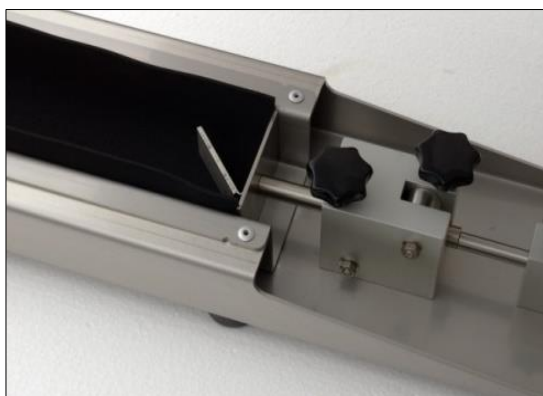
Obr. 66, 67: Zkušební zařízení Schleibinger Geräte určené ke stanovení objemových změn betonu [O4]
