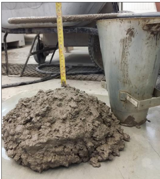
Obr. 62, 63: Stanovení konzistence betonu metodou sednutí kužele dle ČSN EN 12350 – 2 [N4] v čase 5 (vlevo) a 30 minut (vpravo) od zamíchání
