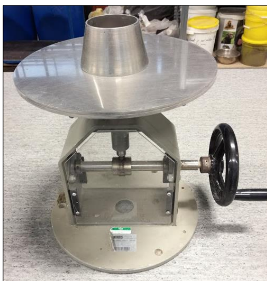
Obr. 68, 69: Střásací stůl pro určení konzistence cementové malty dle ČSN EN 1015 – 3 [N21] a zkušební zařízení Calmetrix f-cal 8000 určené pro měření vývoje hydratačních teplot [O34]
