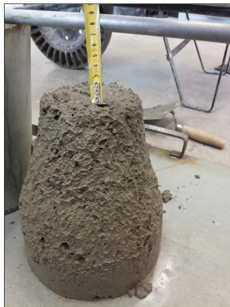
Obr. 62, 63: Stanovení konzistence betonu metodou sednutí kužele dle ČSN EN 12350 – 2 [N4] v čase 5 (vlevo) a 30 minut (vpravo) od zamíchání
