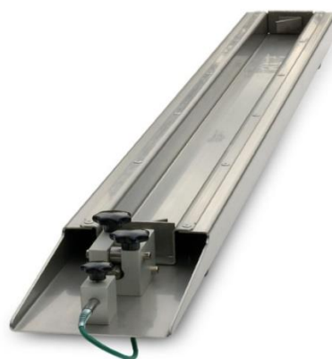
Obr. 66, 67: Zkušební zařízení Schleibinger Geräte určené ke stanovení objemových změn betonu [O4]
