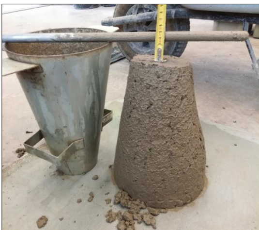
Obr. 64, 65: Stanovení konzistence betonu metodou sednutí kužele dle ČSN EN 12350 – 2 [N4] v čase 60 (vlevo) a 90 minut (vpravo) od zamíchání
