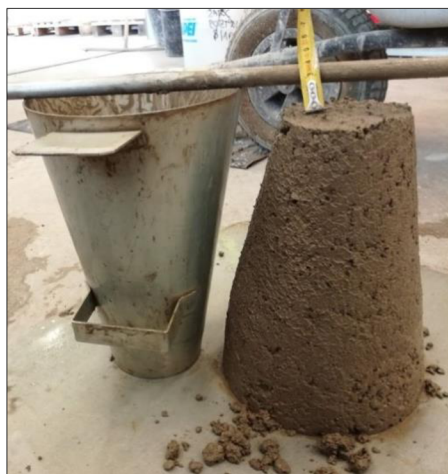
Obr. 64, 65: Stanovení konzistence betonu metodou sednutí kužele dle ČSN EN 12350 – 2 [N4] v čase 60 (vlevo) a 90 minut (vpravo) od zamíchání
