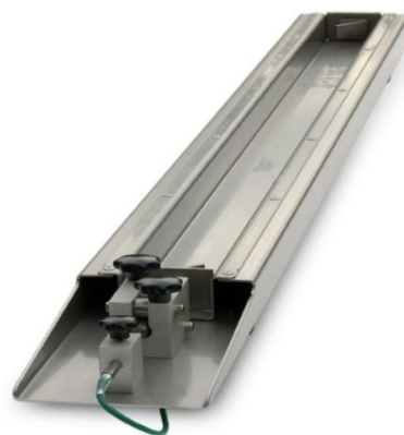
Obr. 66, 67: Zkušební zařízení Schleibinger Geräte určené ke stanovení objemových změn betonu [O4]
