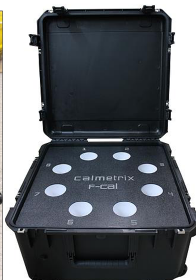
Obr. 68, 69: Střásací stůl pro určení konzistence cementové malty dle ČSN EN 1015 – 3 [N21] a zkušební zařízení Calmetrix f-cal 8000 určené pro měření vývoje hydratačních teplot [O34]
