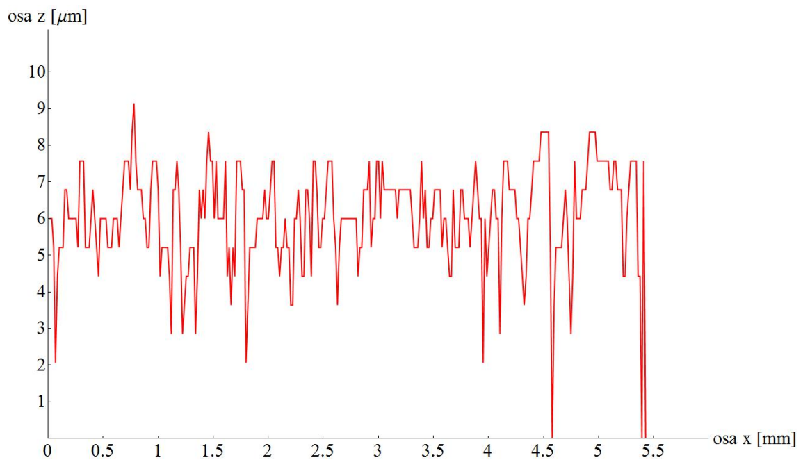
Obrázek 74 | Příčný řez naměřeného výškového profilu ocelové destičky s frézovaným povrchem odpovídající červené linii na Obrázku 73.
