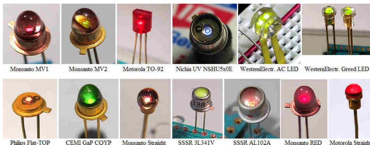
Obr. 3-61 Světelné diody 70. léta [66].
