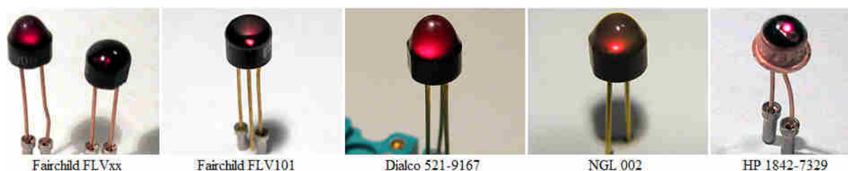
Obr. 3-60 Světelné diody 60. léta [66].
