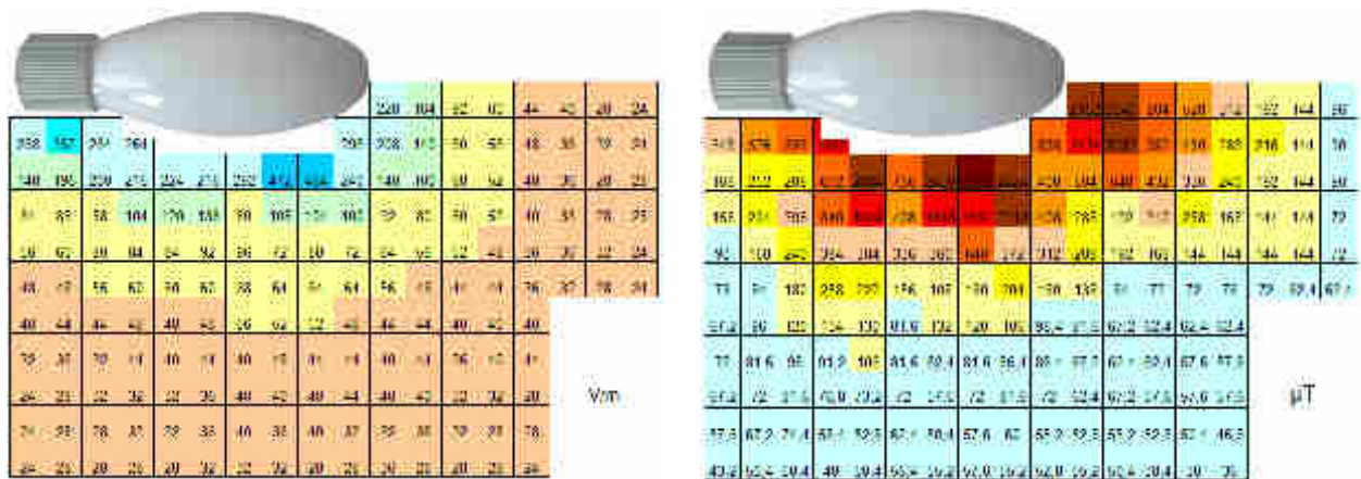
Obr. 2-45 Distribuce elektrického a magnetické pole v okolí indukční zářivky BLJDY-135 [32].
