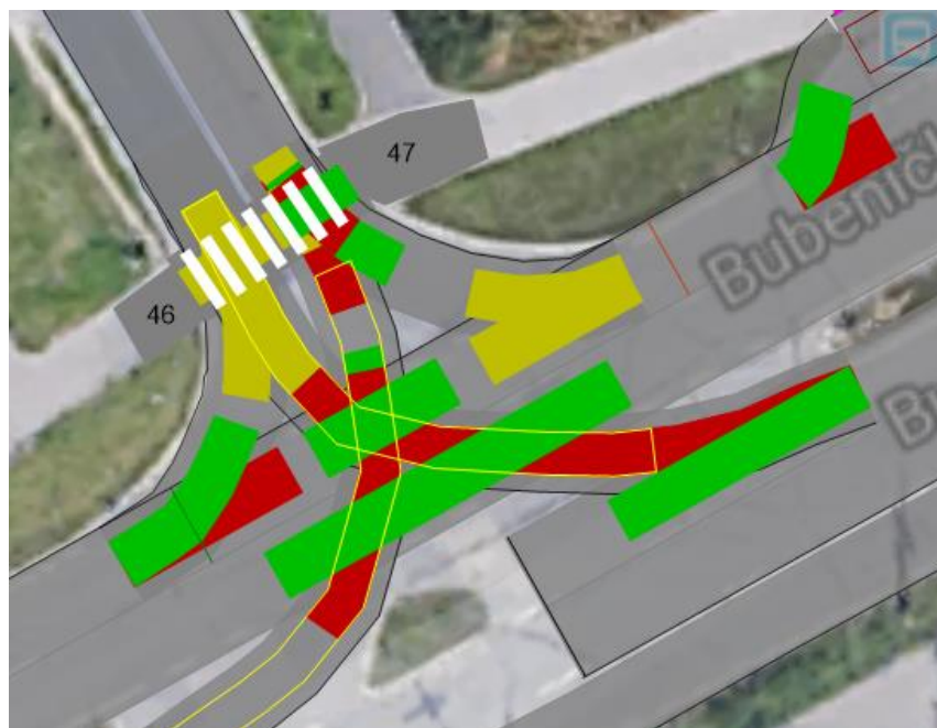
Obrázok 18. Ukážka konfliktných bodov v križovatke. Vozidlo v zelenom pruhu má prednosť pred vozidlom v červenom. Žltá vyjadruje neutrálnosť.
