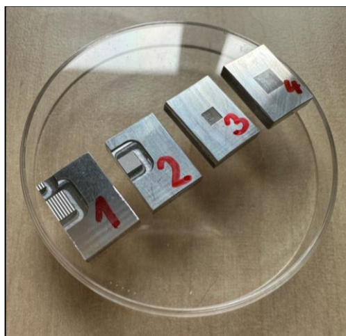
Obr. 5.2 Obrobené hierarchické mikrostruktury mikrofrézováním
