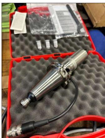
Obr. 3.4 - Vysokofrekvenční vřeteno, výrobce: SEMACO
