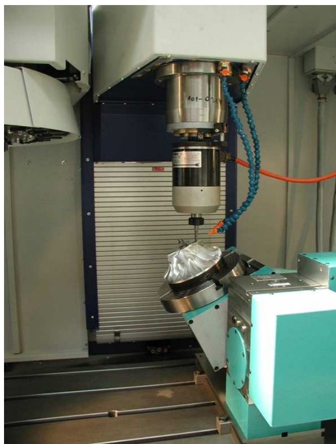
Obrázek 9 - Volitelné provedení pro otočnou 4. a 5. Osu
