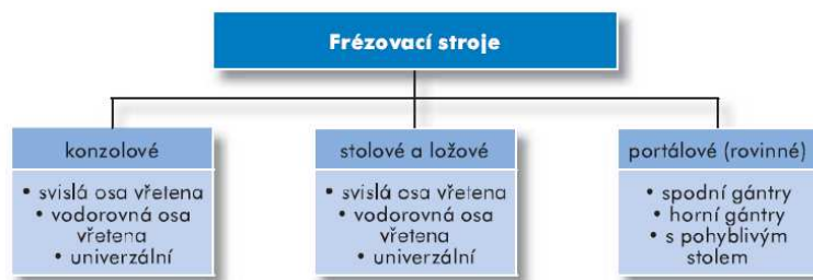
Obrázek 1 - Rozdělení frézovacích strojů
