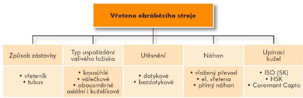
Obrázek 30 - Vřeteno obráběcího stroje
