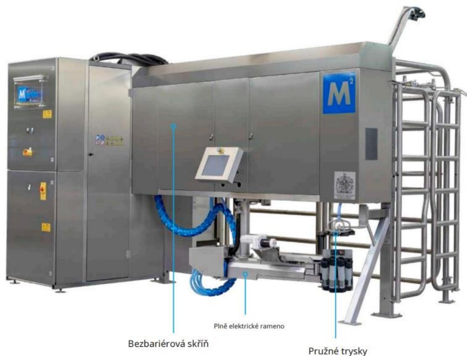
Obrázek 1 Dojící robot M2erlin Fullwood, převzato z technického návodu Fullwood
