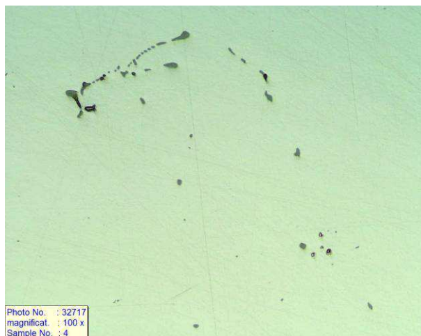
Obr.6.16a a 6.16b Sulfidy II. typu, a oxidy i karbonitridy zirkonu, zvětšení 100x
