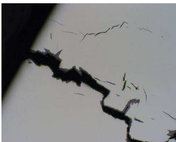
Obr.3.8a Lineární vada ( 100x)
