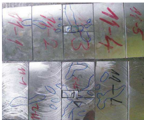
Obr.6.52 Vady po TZ v podnálitkové oblasti
