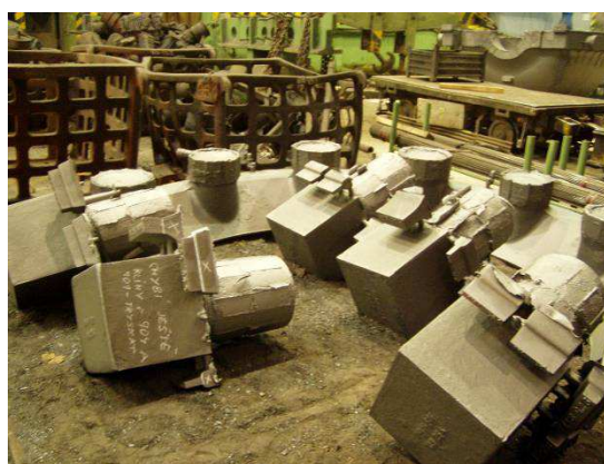
Obr.6.1a a 6.1b Formy a surové odlitky zkušebních kostek o hraně 500mm
