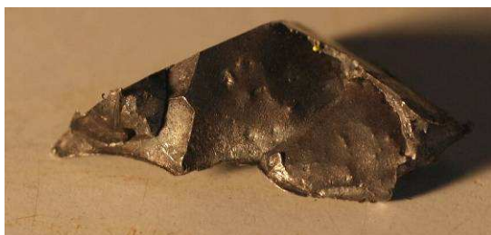
Obr.2.16 Lasturový lom a AlN po hranicích zrn z podnálitkové oblasti masivního odlitku z materiálu GS20Mn5, obsah Al 0,027% , produkce ŽĐAS a.s.
