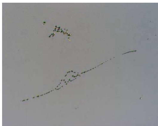
Obr.2.12 Oblasti výskytu jednotlivých typů vměstků uhlíkových ocelí, příklad sulfidů II.typu
