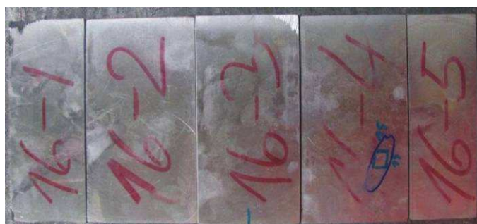
Obr.6.63 Vady na řezu nálitku v litém stavu
