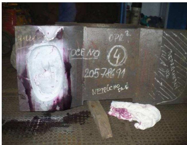
Obr.3.14 Odliitek ložiska po vydrážkování vad a vzhled defektů při EMG kontrole
