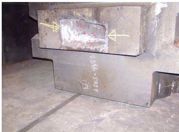
Obr.3.11b Odlitek ložiska po vydrážkování vad
