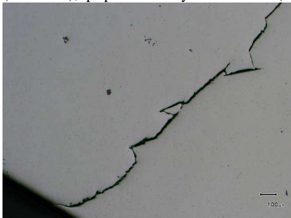
Obr.3.17a Trhlinky v podnálitkové oblasti (100x)
