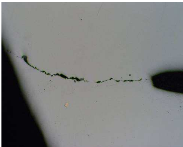
Obr.3.12a Mikrořediny propojené lineár.vadami (100x) 3.12b Sulfidy II.typu
