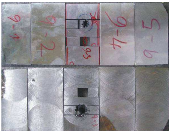
Obr.6.39 Vady na řezu nálitku v litém stavu
