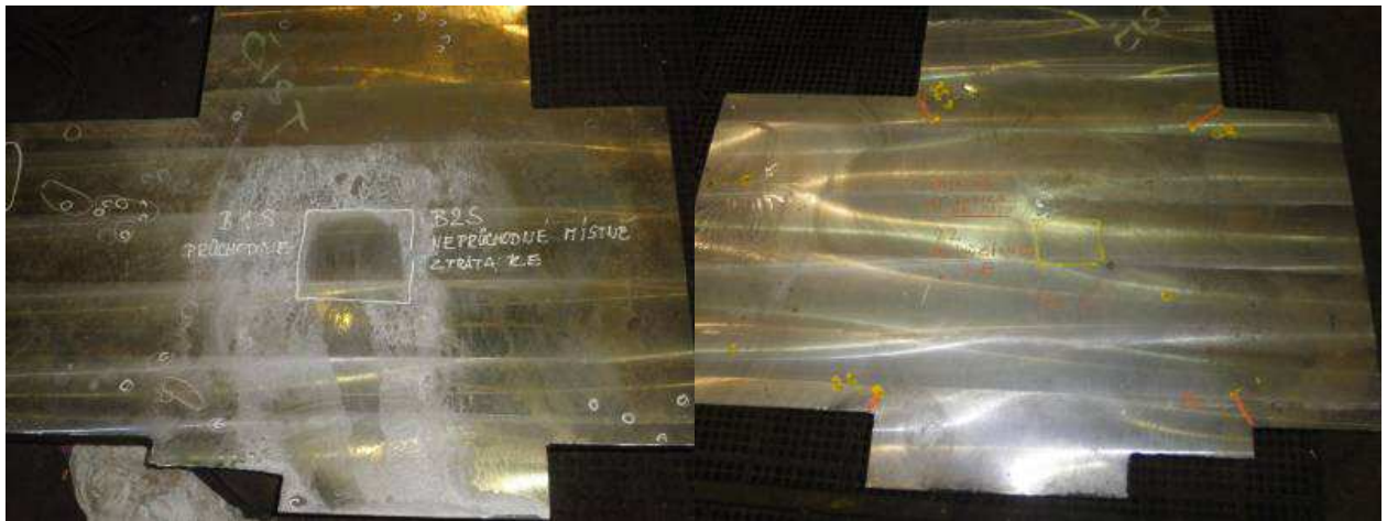
Obr.6.93a a 6.93b Vady po TZ v podnálitkové oblasti
