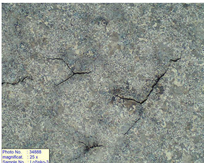
Obr.3.15a Trhlinky po hranicích prim. zrna (25x) 3.15b Shluky oxidů Zr (100x)
