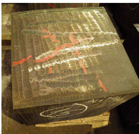
Obr.6.57 Vady na řezu nálitku v litém stavu
