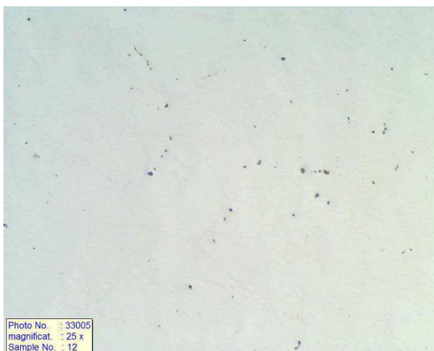
Obr.6.74 Oxidy i nitridy Zr, sulfidy II a III typu, zvětšení 25x
