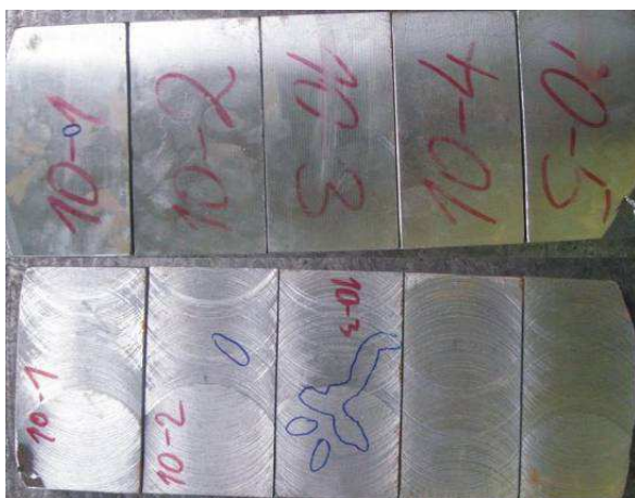
Obr.6.45 Vady na řezu nálitku v litém stavu
