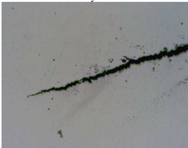
Obr.3.21 Lineární vady v podnálitkové oblasti stojanu (100x)
