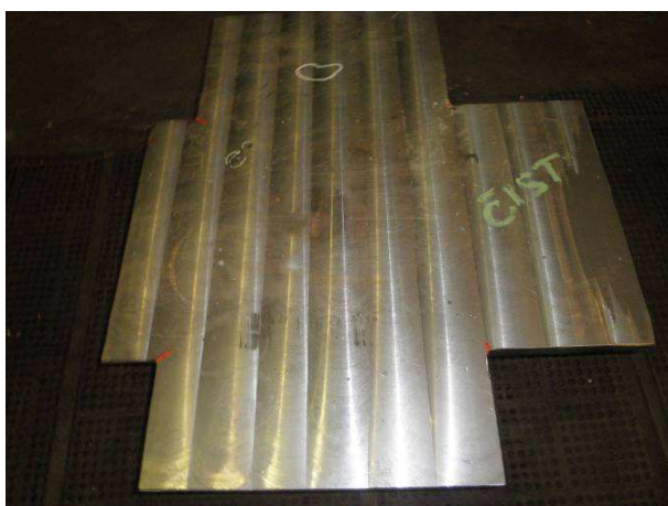
Obr.6.103a a 6.103b Vady po TZ v podnálitkové oblasti
