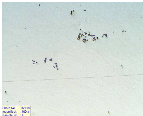
Obr.6.16a a 6.16b Sulfidy II. typu, a oxidy i karbonitridy zirkonu, zvětšení 100x
