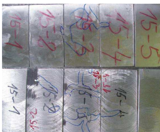
Obr.6.58 Vady po TZ v podnálitkové oblasti
