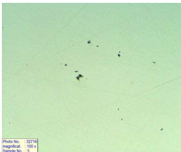
Obr.6.12 Vměšky v oceli, zvětšení 100x
