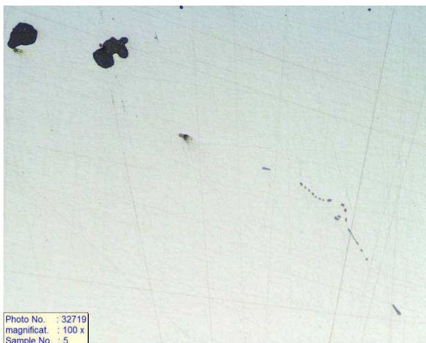
Obr.6.4 Vměstky v oceli, zvětšení 100x
