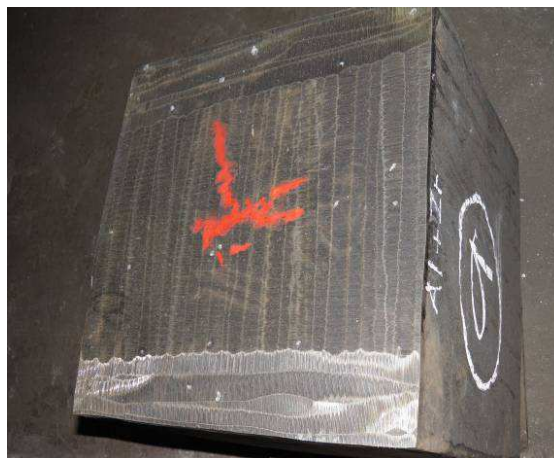
Obr.6.40 Vady po TZ v podnátíkové oblasti
