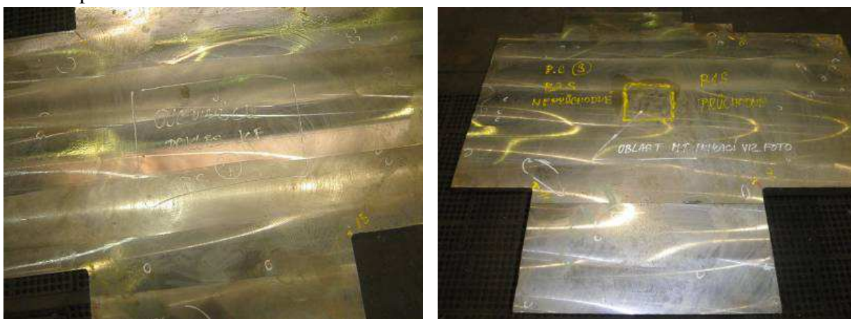
Obr.6.98a a 6.98b Vady po TZ v podnátkové oblasti
