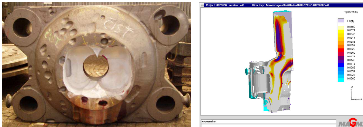
Obr.2.5a a 2.5b Masivní odlitek s výskytem vycezenin, zpětně detekovaných sw. MAGMASoft[7]
