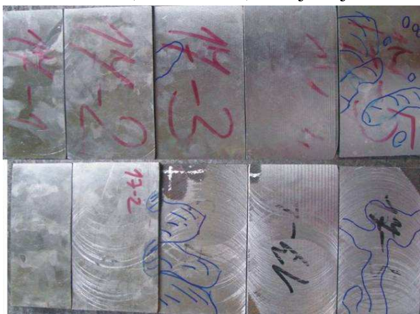
Obr.6.69 Vady na řezu nálitku v litém stavu
