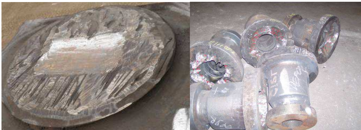
Obr.2.30 Příklady vzhledu prasklin v podnálitkových oblastech ocelových odlitků
