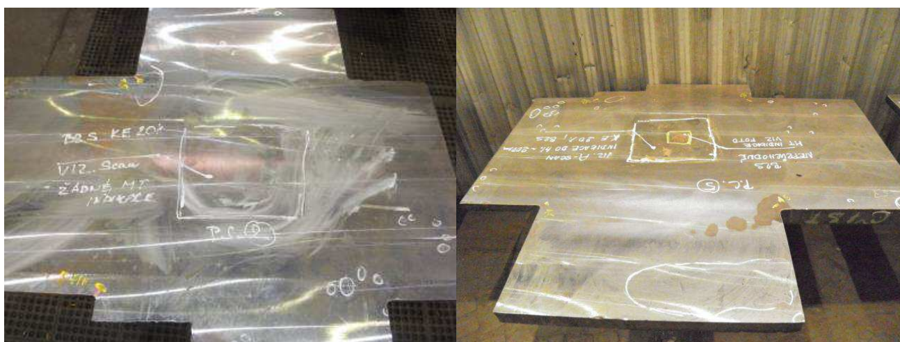
Obr.6.88a a 6.88b Vady po TZ v podnálitkové oblasti
