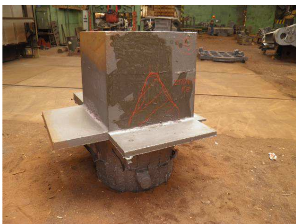
Obr.7.13 UZ neprůchodnost v litém stavu
