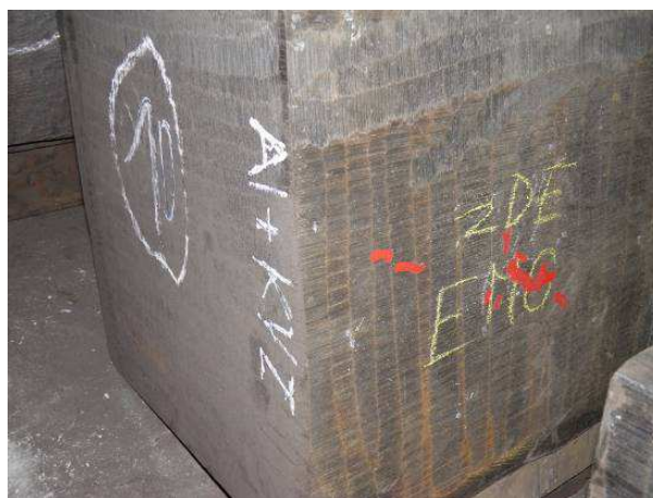
Obr.6.46 Vady po TZ v podnálitkové oblasti
