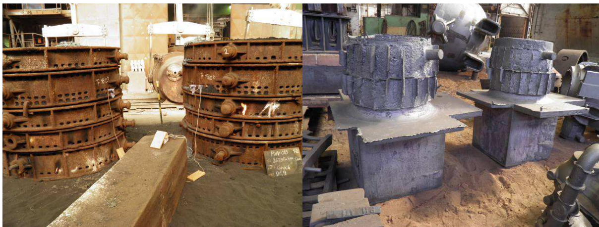
Obr.6.84 Formy a surové odlitky zkušebních kostek o hraně 750mm
