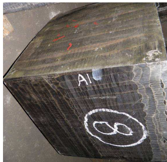
Obr.6.34 Vady po TZ v podnálitkové oblasti
