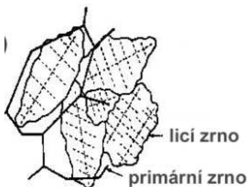
Obr.2.8 Schematické znázornění granulace zrn
