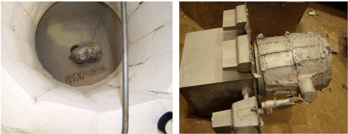
Obr.6.29a a 6.29b Formy a surové odlitky zkušebních kostek o hraně 500mm
