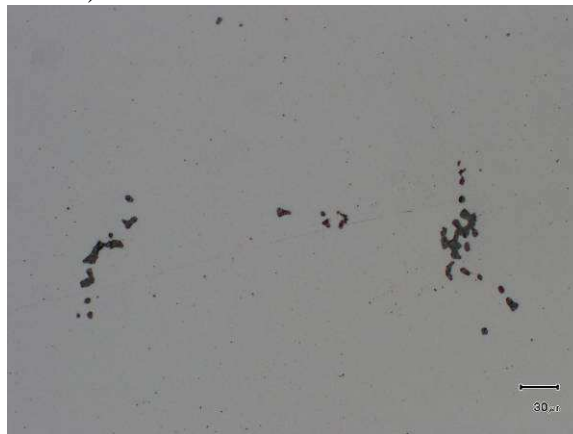
3.17b Sulfidy tamtéž (100x )
