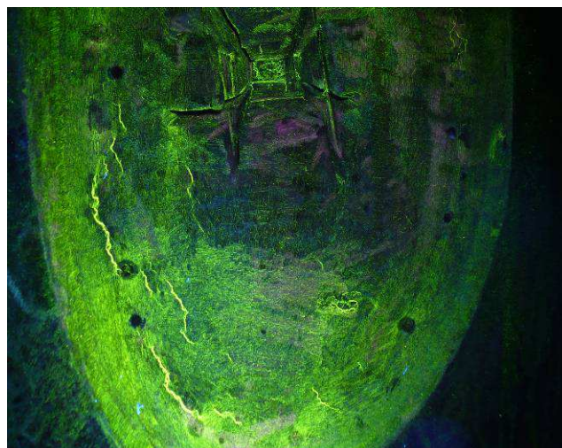
Obr.3.14 Odliitek ložiska po vydrážkování vad a vzhled defektů při EMG kontrole
