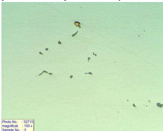
Obr.6.8 Vměstky v oceli, zvětšení 100x
