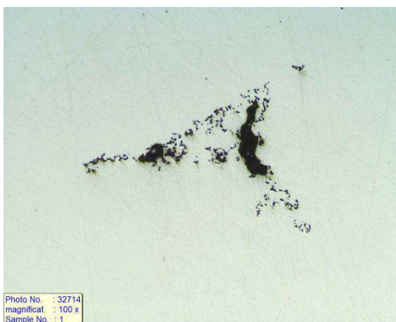
Obr.6.20 Shluky Al_2O_3 , zvětšení 100x
