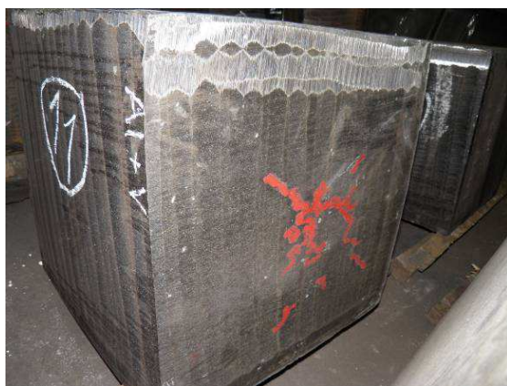
Obr.6.51 Vady na řezu nálitku v litém stavu
