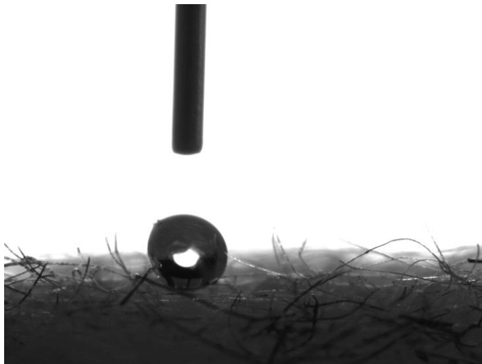
Obrázek 9 – Měření kontaktního úhlu banánových textilií
