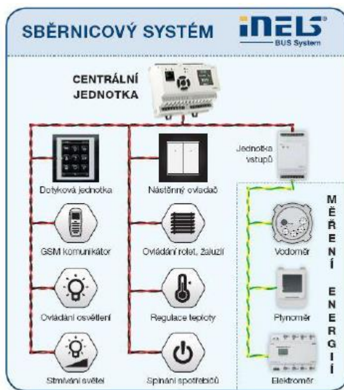
Obr. 4-1 Topologie sběrnice CIB systému INELS [4]
