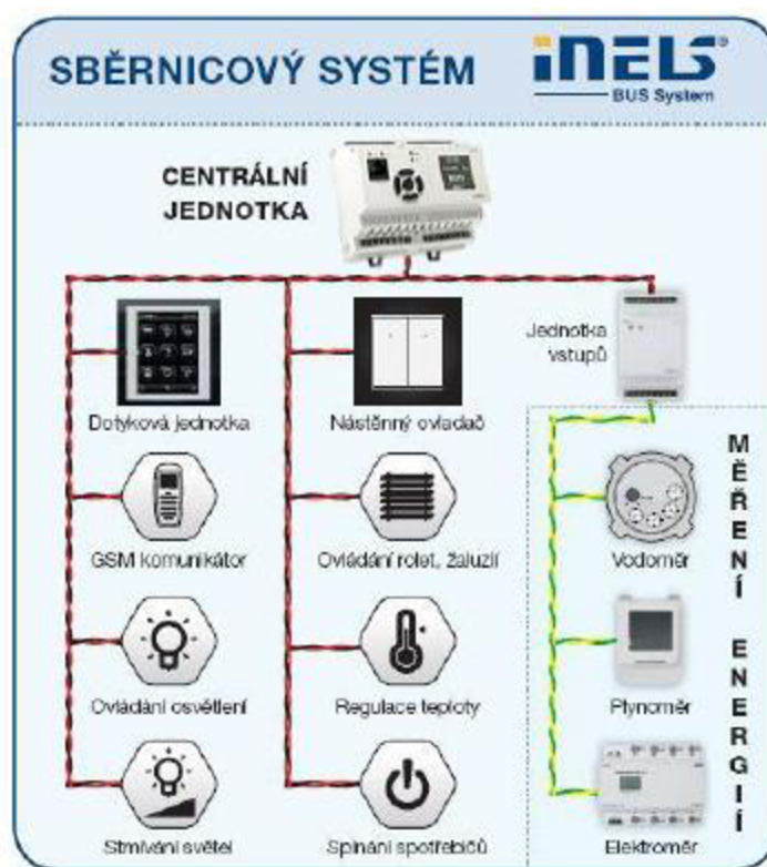
Obr. 4-1 Topologie sběrnice CIB systému INELS [4]
