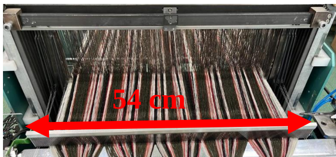
Obr. 22: Paprsková šířka, maximální šířka 54 cm
