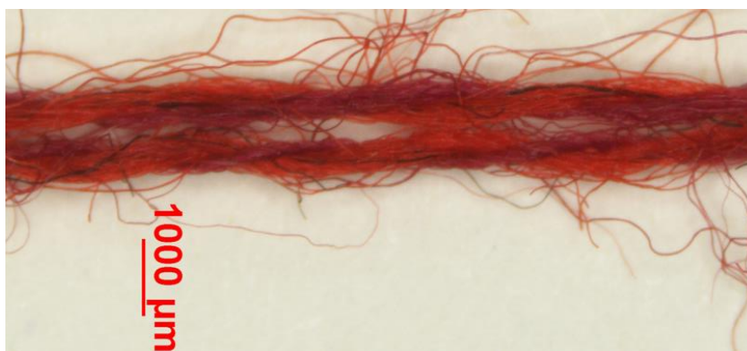
Obr. 26: Dvě zakoupené příze o jemnostech 70tex
