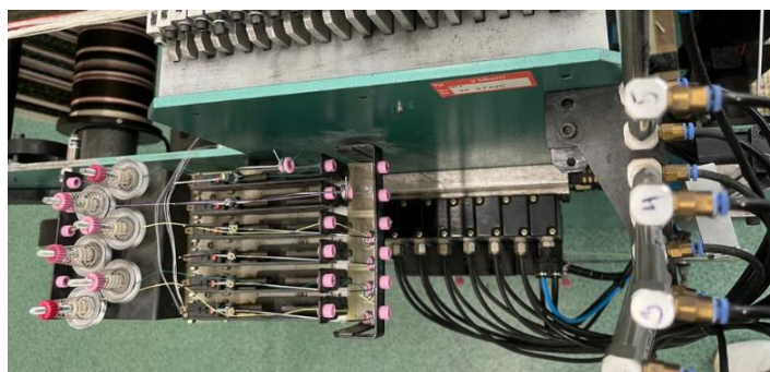
Obr. 24: Útková barevná záměna, maximálně 6 barevných záměn
