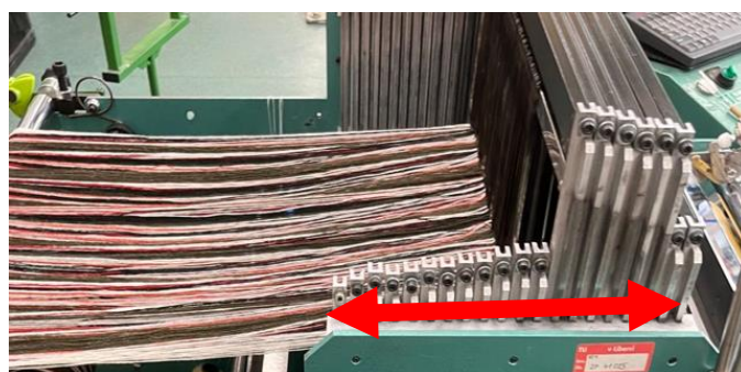
Obr. 23: Prošlupní mechanismus, celkem 20 listů
