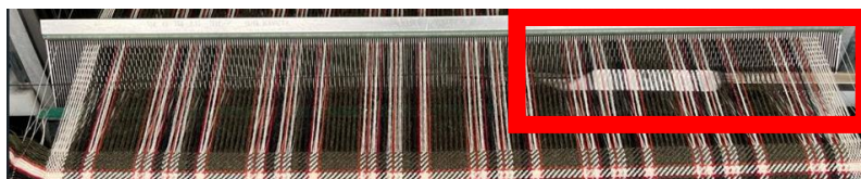
Obr. 25: Jehlový prohozní mechanismus
