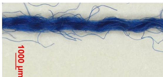
Obr. 18: Příze po vyparání z tkaniny Czech National Tartan
