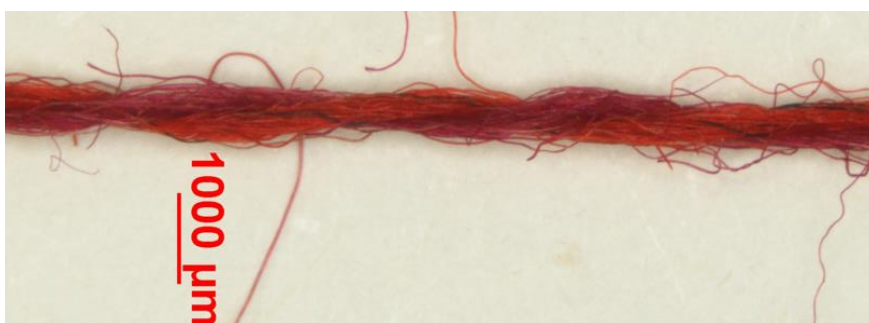
Obr. 28: Dvojnásobně skaná příze 140tex
