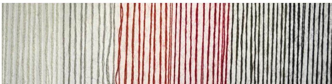
Obr. 29: Výběr barevných přízí pro experimentální sady o jemnosti 140tex
