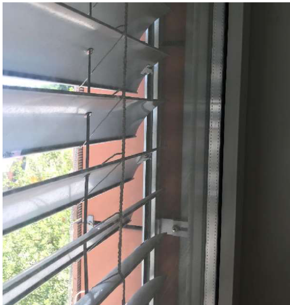
Obrázek 61 Fotografie z měření – sklon lamel 30°
