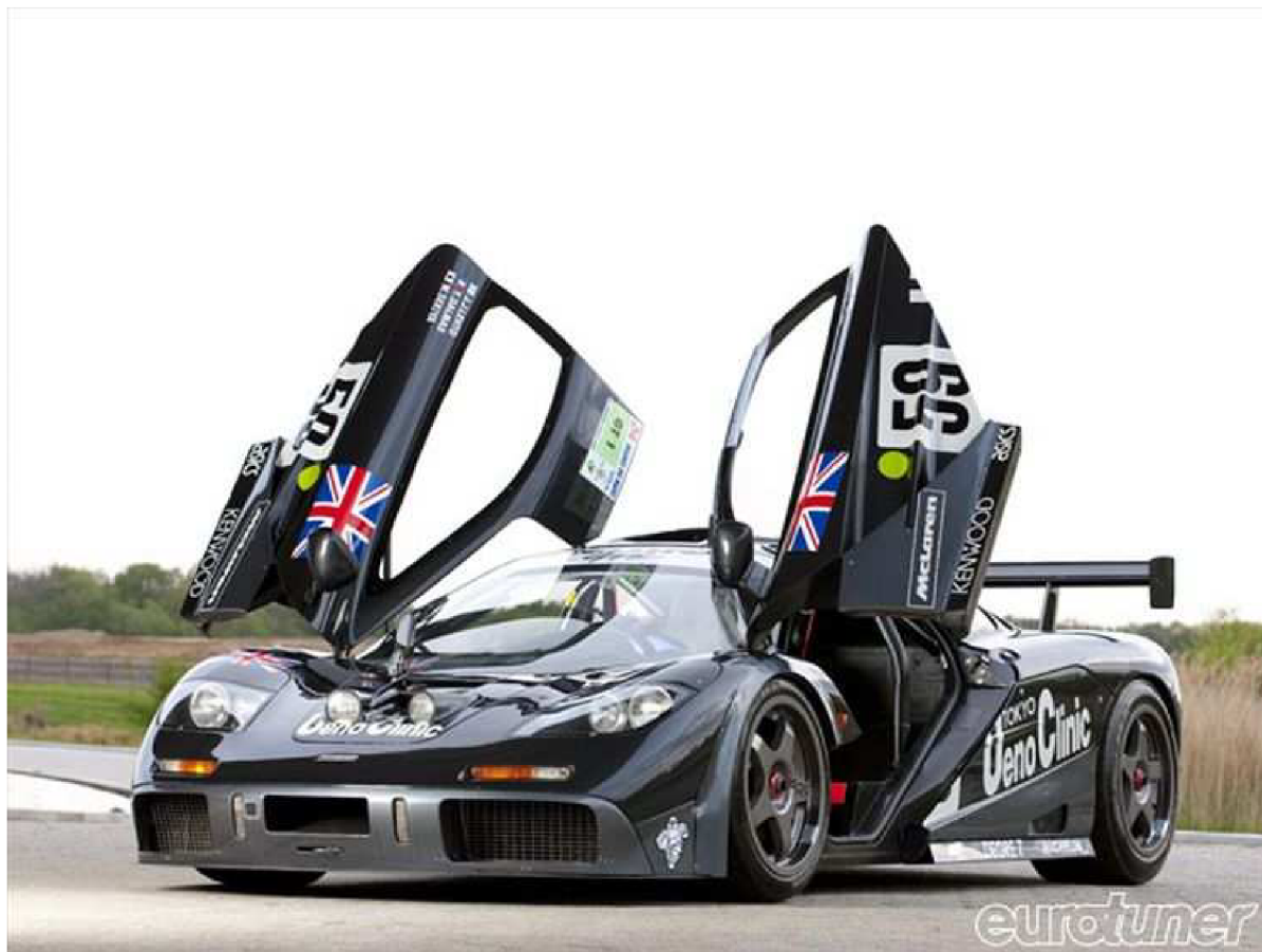
Obrázek 2 : Butterfly doors na automobilu McLaren F1 [9]
