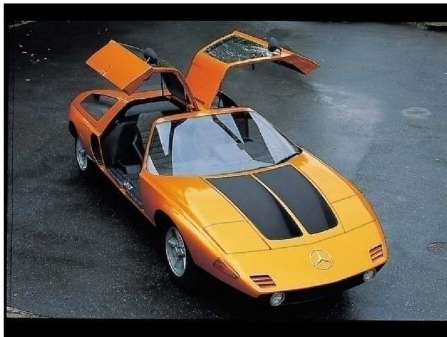
Obrázek 3: Gullwing doors na voze Mercedes-Benz C 111 [15]
