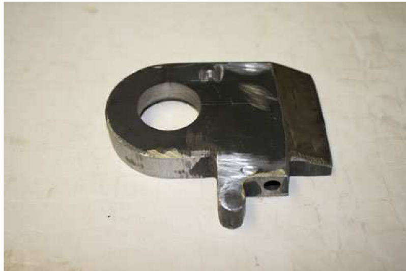
Obrázek 19 : Sražení na spojovacím dílu
