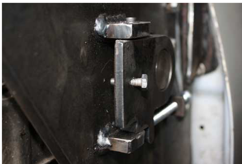
Obrázek 27 : Regulace otevření dveří klasickým způsobem
