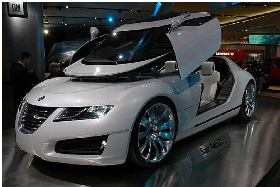
Obrázek 5: Canopy doors na automobilu Saab Aero X [14]
