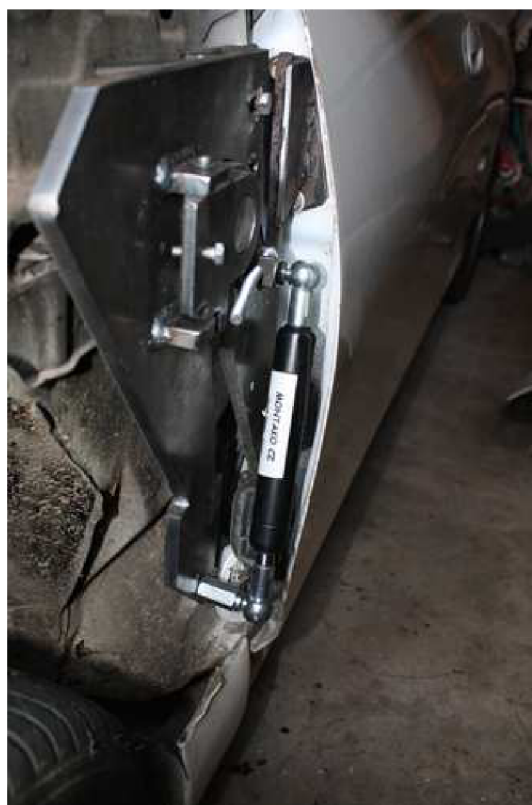
Obrázek 28 : Závěs při zavřených dveřích
