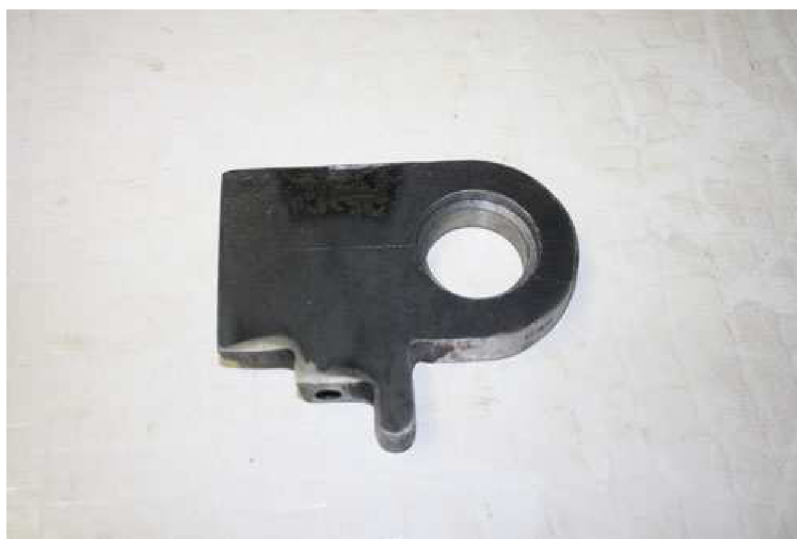
Obrázek 18 : Spojovací díl s dírami pro hřídele
