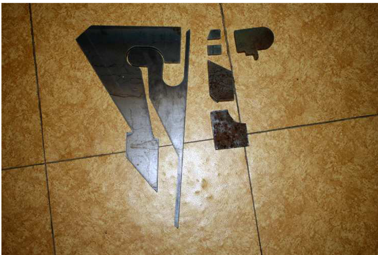
Obrázek 13: Díly závěsu ze strojní plasmové řezačky
