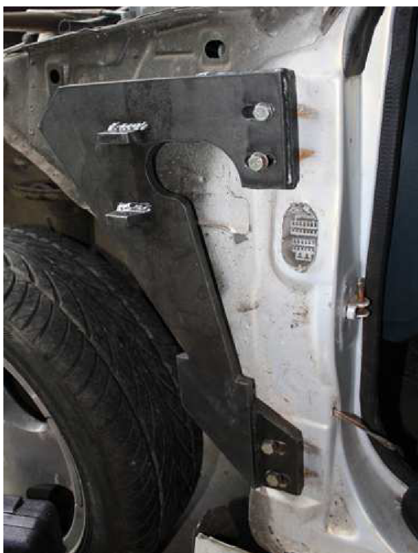
Obrázek 22 : Díl uchycený pod blatníkem
