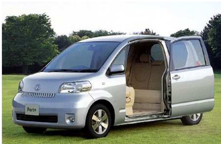
Obrázek 6: Sliding doors na voze Toyota Porte [10]
