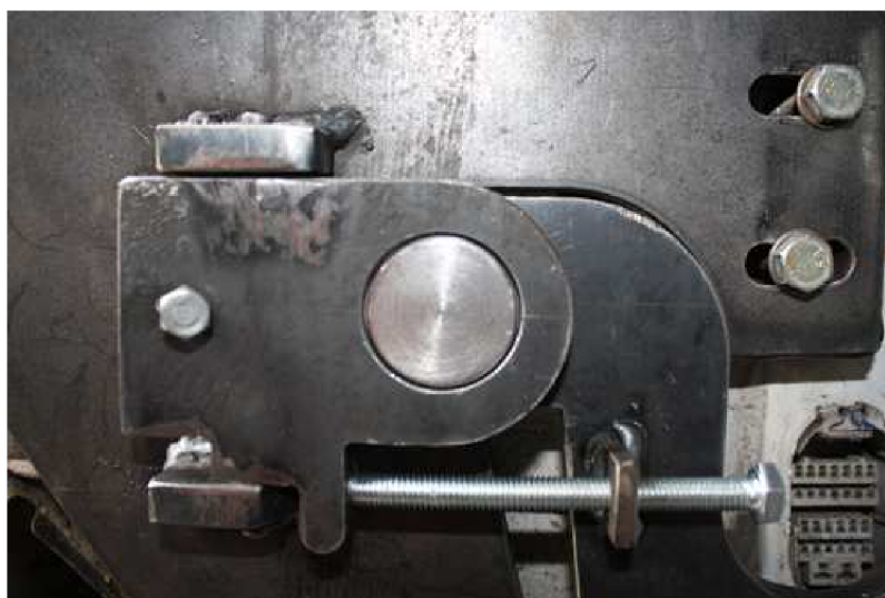
Obrázek 26 :Doraz. spodní polohy dveří
