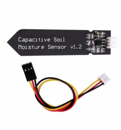
Obrázek 16 Capacitive soil moisture sensor v1.2 [57]
