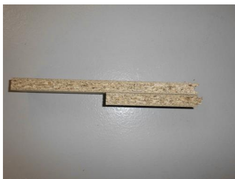
Obr. 5 Vzorek dřevotřískové desky se dvěma spoji po ohybové zkoušce
