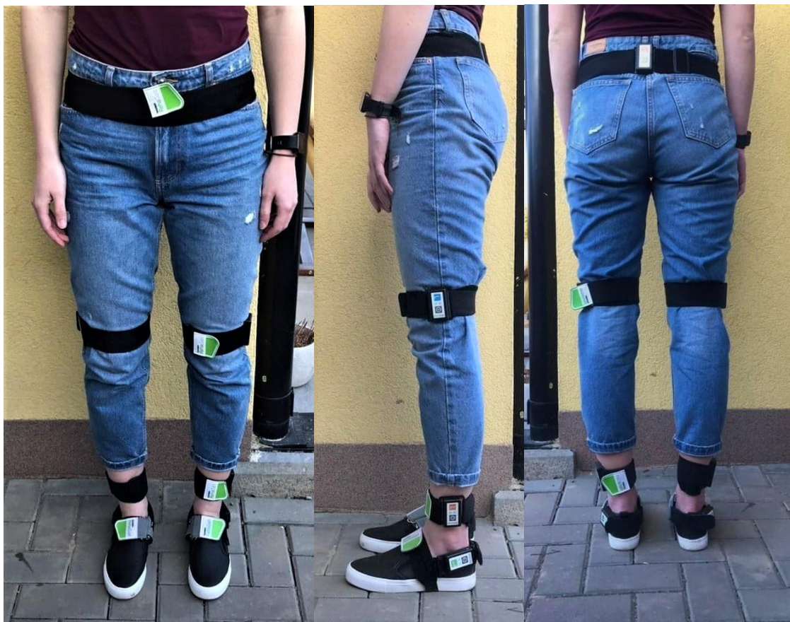
Obrázek 5. Umístění senzorů přístroje RehaGait – pohled zepředu, z boku a zezadu (Archiv Autora, 2021)
