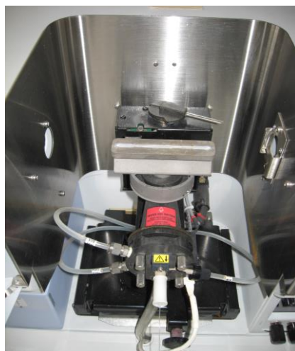
Obrázek 8: Prostor hořáku v AAS s plamenovou atomizací
