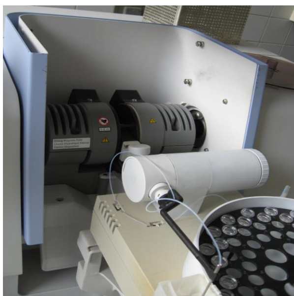
Obrázek 10: Kyvetový prostor s magnety u ETA AAS a část podavače vzorků < vlastní fotografie >
