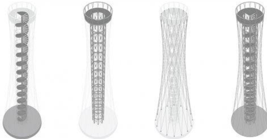
Obrázek 5 Konstrukce rozhledny Holedná v Brně [23]
