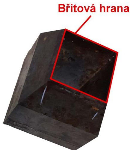
Obrázek 8: Vysekávací nůž na vzorky
