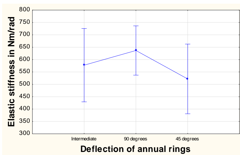
Graf 3: účinek faktoru odklonu letokruhu na tuhost spoje
