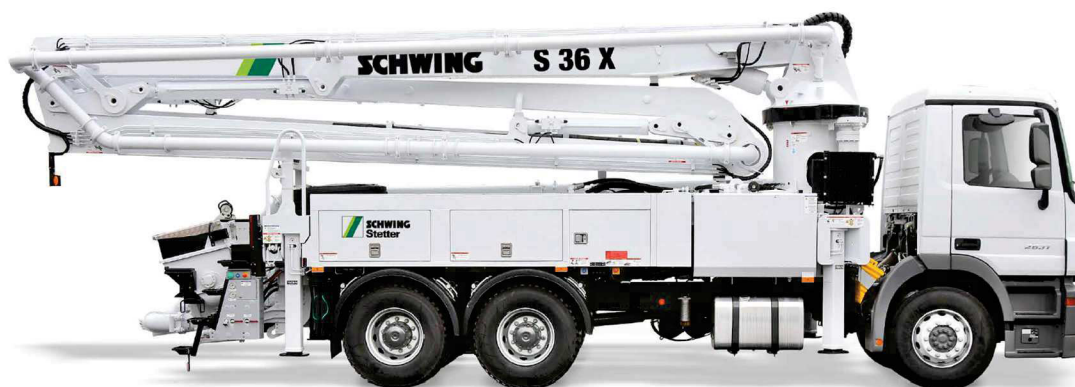
Obrázek 6-9 Čerpadlo čerstvého betonu
