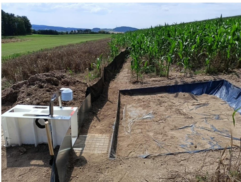
Obr. č. 20 - Geotextílie v podélném sklonu cca 1° svede povrchový odtok do nejnižšího místa odtokové parcelky, kde se nachází sedimentační jímka a Parshallův žlab (Kalibová a kol 2022).
