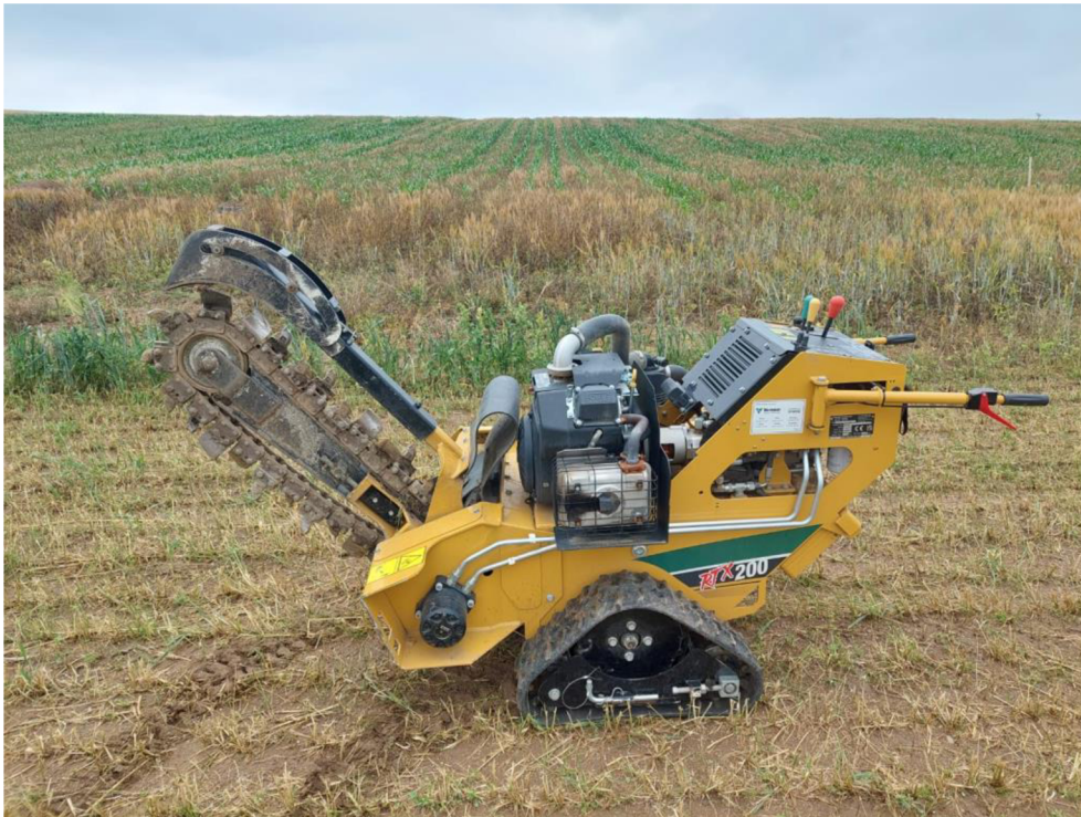
Obr. č. 19 - Rýhovač Vermeer RTX200 (foto vlastní 6/2022).
